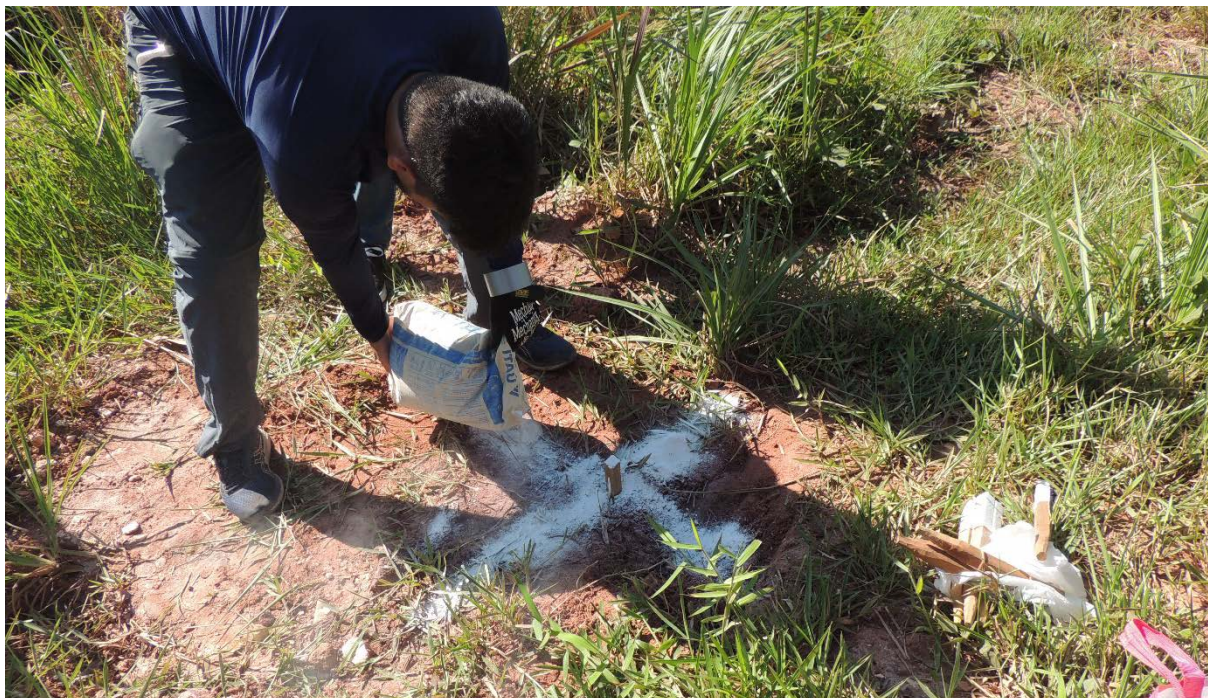
Figura 19 - Marcação com cal dos pontos que foram aferidos
