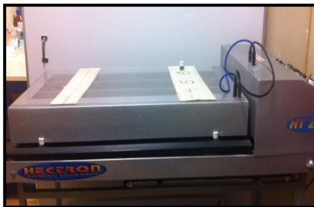
Figura 4 - Esteira de treinamento adaptada para ratos
