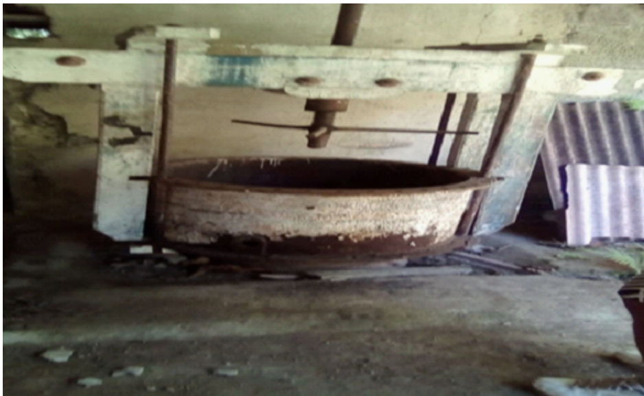
Figura 74 - Tacho utilizado para o cozimento do caldo de cana. Note-se o fogão a lenha abaixo
