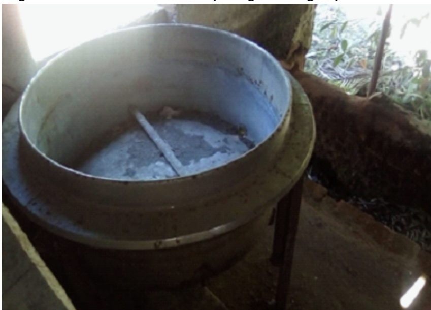
Figura 73 - Tacho de ferro com passagem de água para resfriamento do caldo
