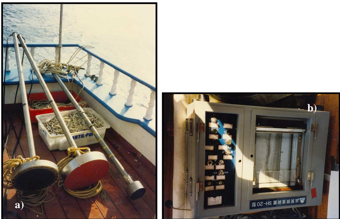
**Figura 33 – Fotografias do Sistema Sembon Denki de perfilagem sísmica: a) emissor e receptor acústico e b) registrador.**
