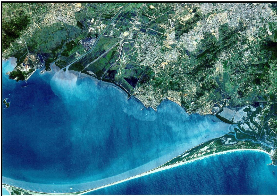
**Figura 132 – Imagem de Satélite na qual Podemos Observar a Pluma de Sedimentos em Suspensão Sofrendo a Ação das Correntes (alterado de Carelli, 2007).**
