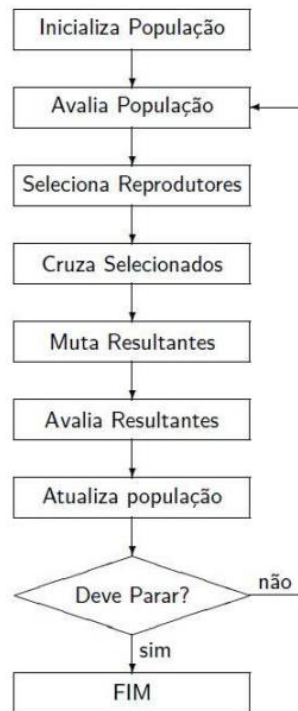
Figura 18 - Estrutura dos algoritmos genéticos (Adaptado de Haupt e Haupt, 2004).
