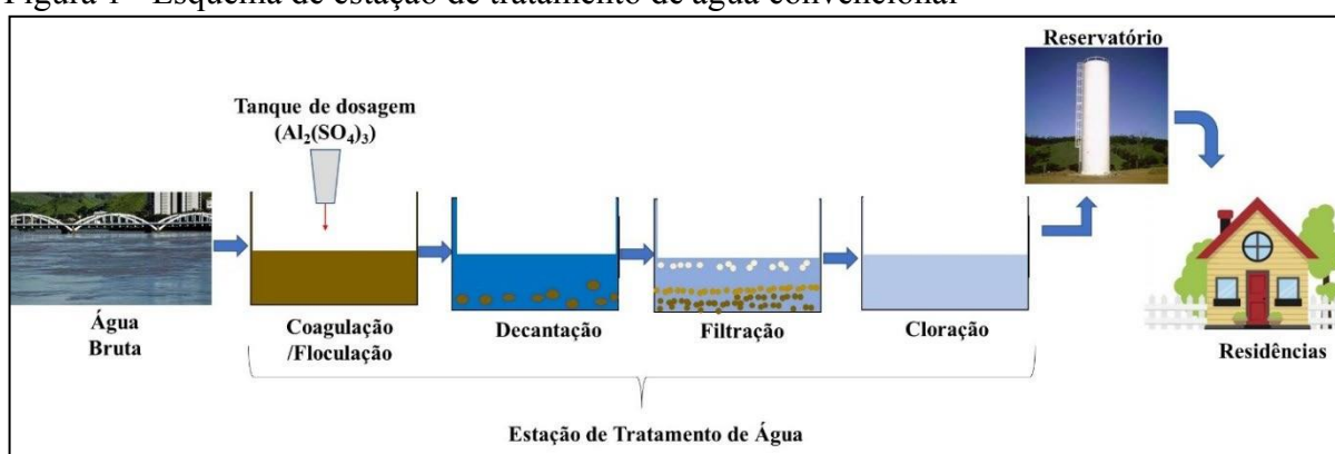
Figura 1 - Esquema de estação de tratamento de água convencional
