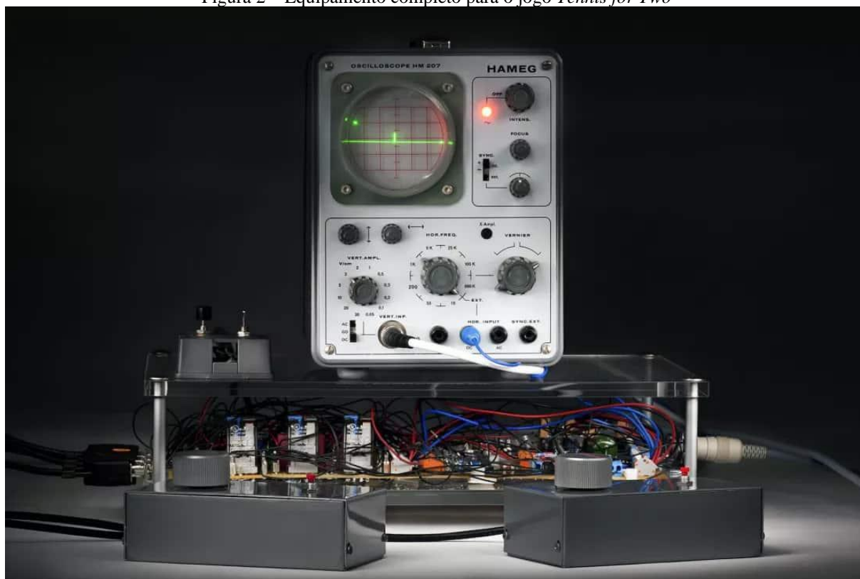
Figura 2 – Equipamento completo para o jogo Tennis for Two
