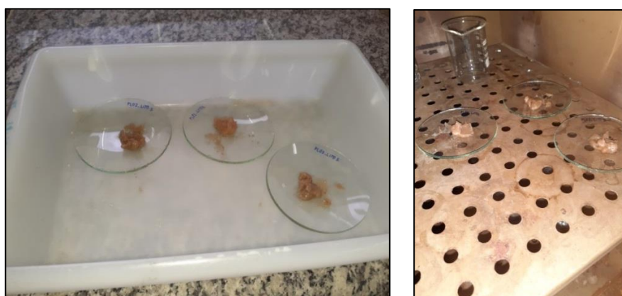
Figura 12: Subamostras com cerca de 2 gramas em vidro de relógio para medição do seu teor de umidade.
