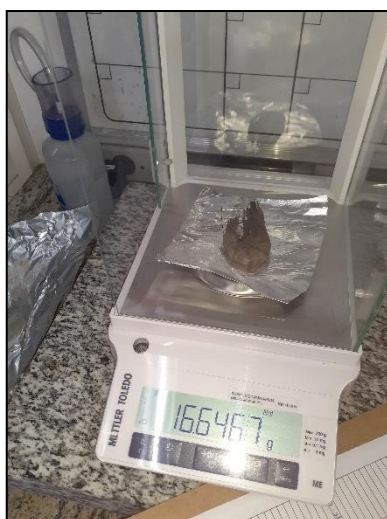
Figura 8: Processo de pesagem em balança analítica realizado nas amostras de camarão coletadas.
