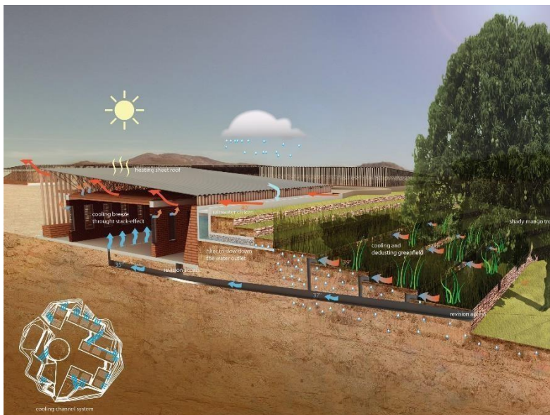
Figura 9- Esquemas de Resfriamento. “Ventilação passiva auxiliada pelas aberturas de janelas e da cobertura dupla.” Fonte. LAFARGEHOLCIM FOUNDATION, 2012
