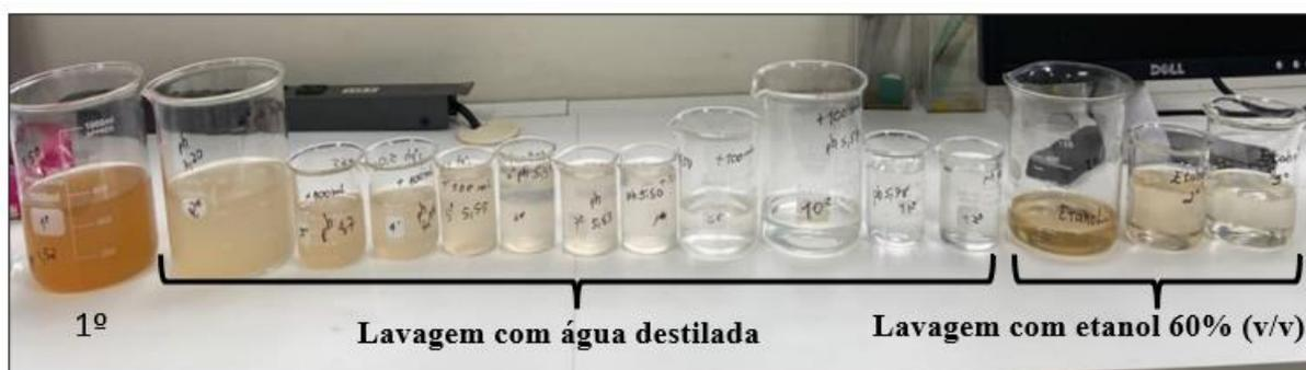
Legenda: Da esquerda para a direita tem-se a sequência de filtrados obtidos após o pré-tratamento. Os últimos três béqueres contém o filtrado após a adição de etanol.
