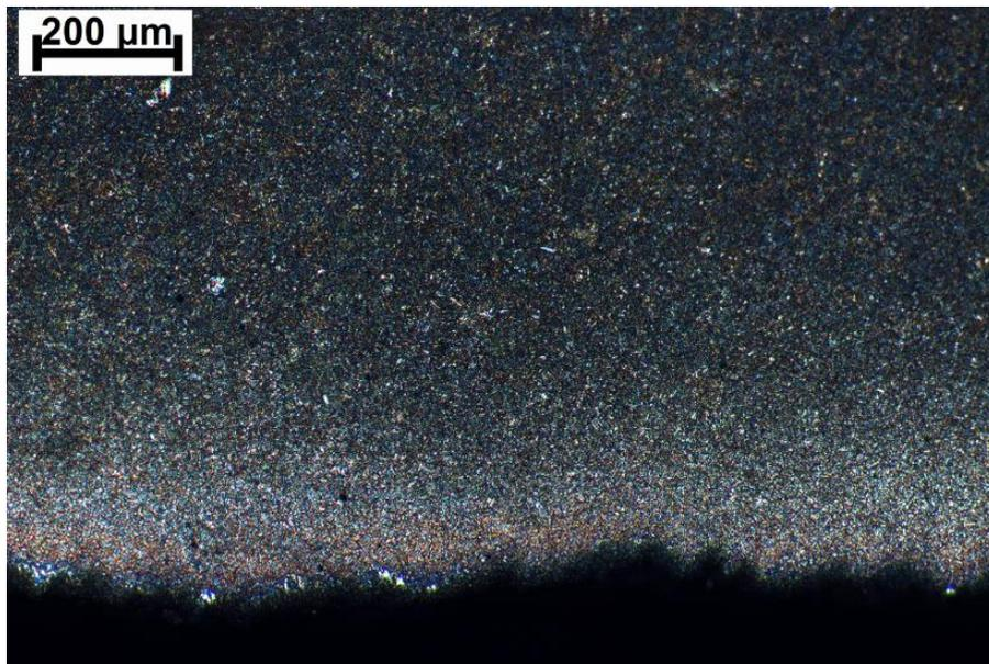
**Figura 40** – Microestrutura de martensita revenida após tratamento térmico de têmpera e revenido refeitos na etapa de simulação do processo. Regiões com menor teor de carbono não foram visualizadas depois do ataque químico. Ataque Nital 5%. MO, aumento de 100x.
