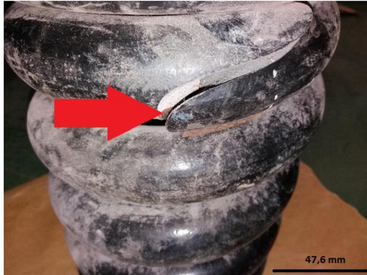
**Figura 29** – Mola retirada do mesmo lote. Fratura semelhante à estudada neste trabalho (CSN, 2017). Uma camada de tinta relativamente fina e com aspecto bastante preservado recobria a superfície das molas.
