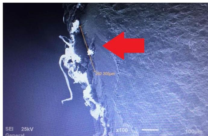
**Figura 33** – Região de provável início da falha e que mostra uma pequena deformação. Imagem obtida em MEV, aumento de 100x.
