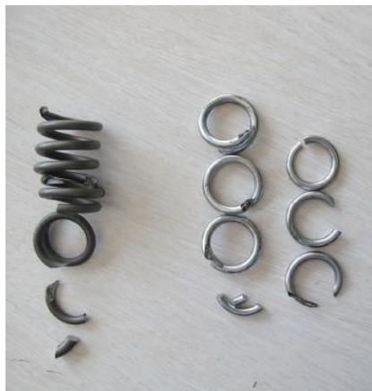
**Figura 21** - Fraturas da mola não revestida (esquerda) e revestida (direita) após ensaio de fadiga (CHAO e GUO, 2016).
