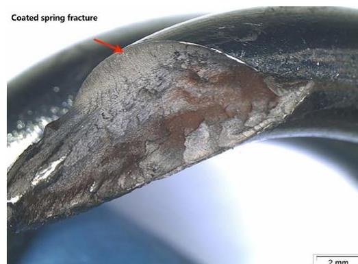
**Figura 22** - Fratura da mola revestida onde a fissura é iniciada a partir do lado externo do diâmetro da bobina; a seta indica o lugar de início da trinca (CHAO e GUO, 2016).
