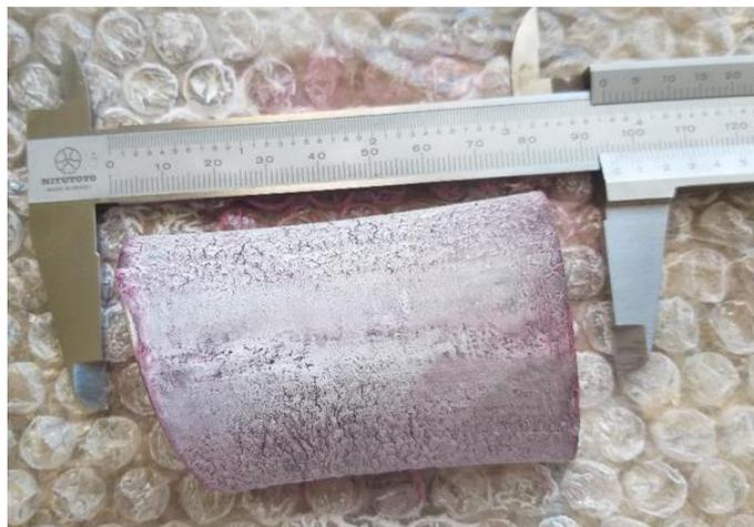
**Figura 37** – Amostra submetida ao ensaio não destrutivo de líquido penetrante para localização de defeitos superficiais. Nenhum defeito foi encontrado, pois a coloração da região avaliada permaneceu homogênea.
