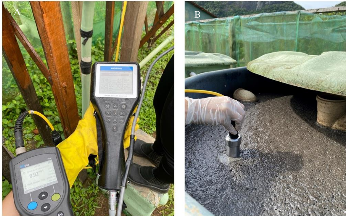
Figura 23 - Sondas utilizadas na pesquisa: (A) Sonda multiparamétrica da Horiba - U-50 e (B) Sonda de OD da Hach – HQ3d.
