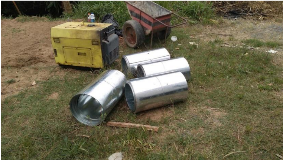
Figura 23 – Chapas de zinco galvanizadas utilizadas para construção do corpo das parcelas.
