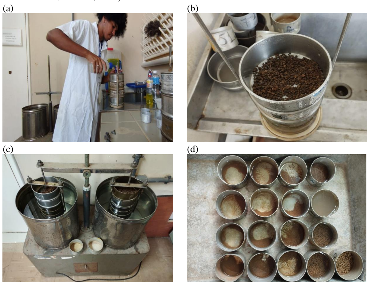
Figura 45 – Ensaio de estabilidade dos agregados. (a) Distribuição dos agregados no jogo de peneiras; (b) Agregados dispostos sobre jogo de peneiras para umedecimento por capilaridade; (c) Aparelho de oscilação vertical (Yoder); (d) Amostras de agregados retidas pelo jogo de peneiras (2 mm - 1 mm - 0,50 mm - 0,25 mm).
