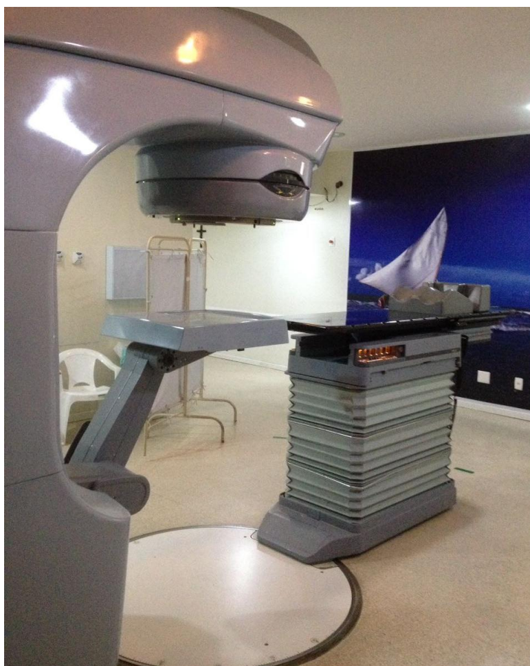
Figura 19 - Set up de irradiação do EPID para realização do controle da qualidade
