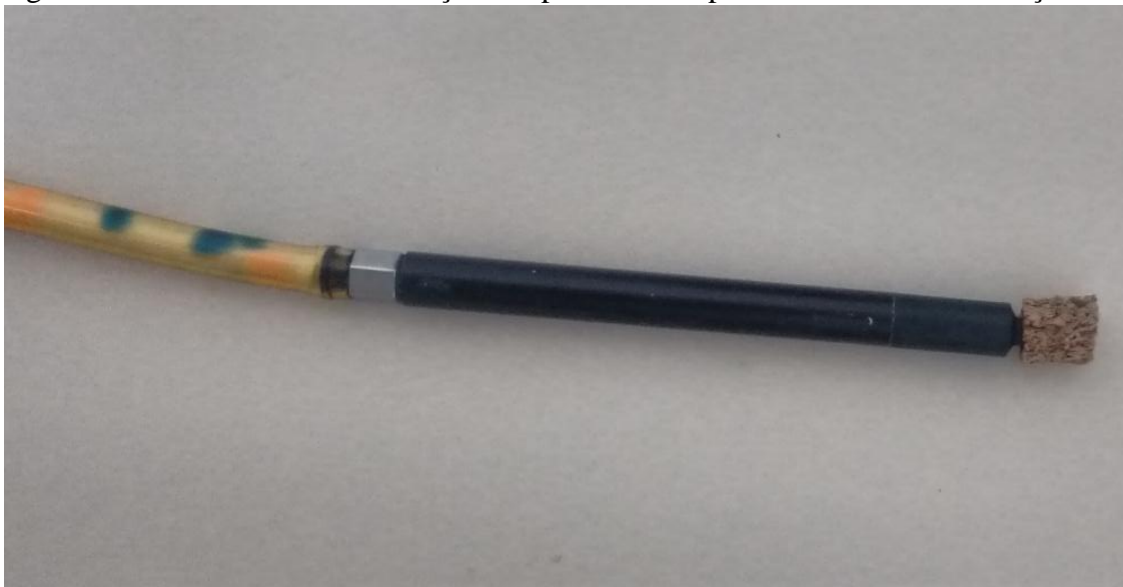
Figura 14 -Microcâmara de Ionização e capa de build up confeccionada em cortiça
