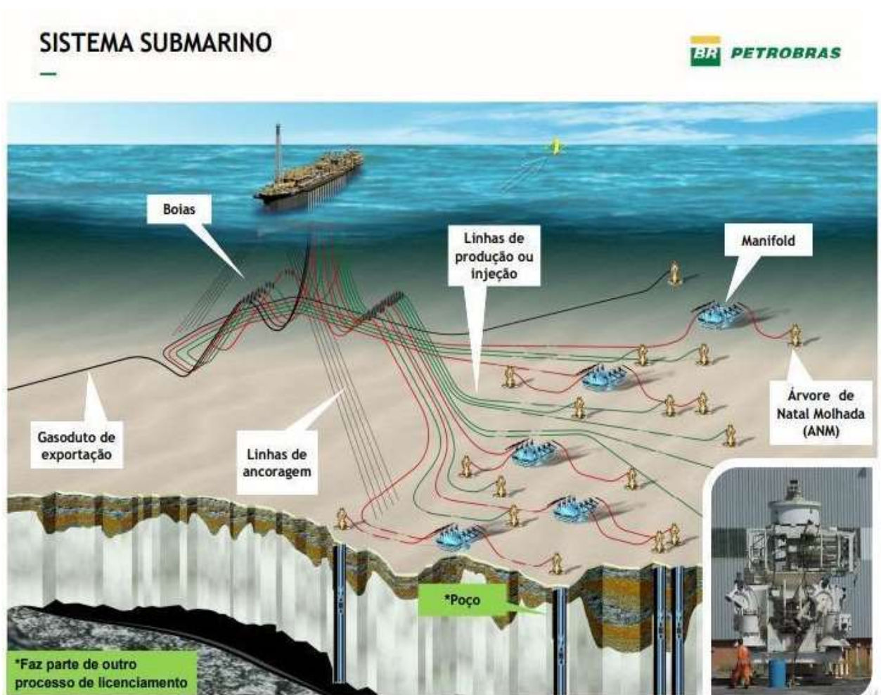
Figura 7 – Esquema representativo ilustrativo dos componentes dispostos em sistema submerso de um navio-plataforma
