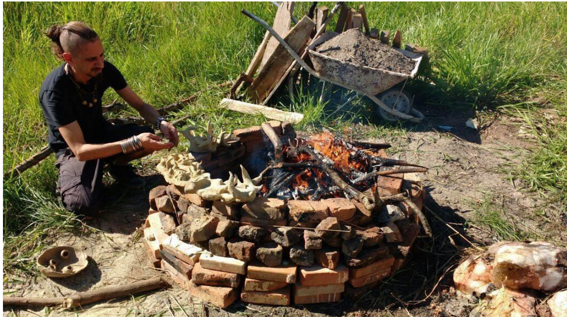
Figura 26 - Experimento de queima com forno aberto na UFRRJ.
