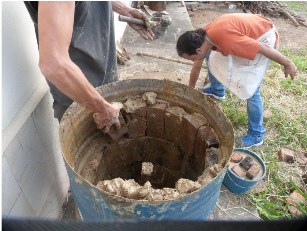
Figura 28 - Montagem do forno de latão do CoAr.
