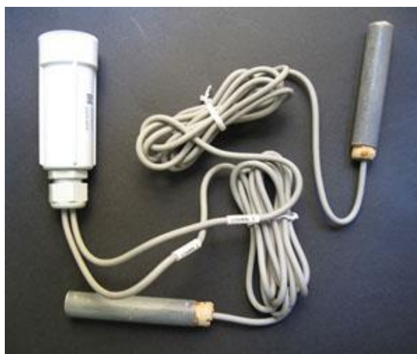
Figura 14 - Hobbo Data Logger (branco) com dois canais acoplados ao modelo de PVC (cinza).
