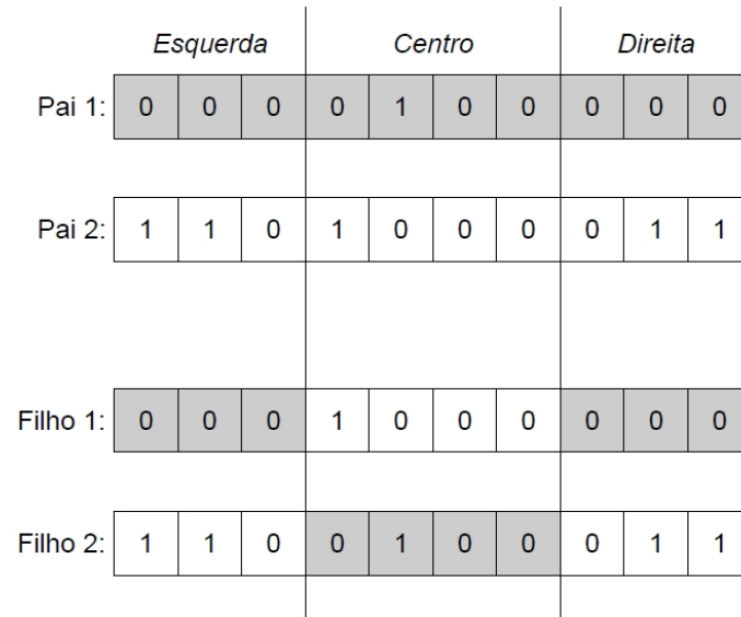
Figura 19 - Representação esquemática do funcionamento do operador de recombinação de múltiplos pontos.
