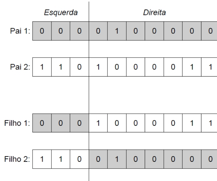
Figura 18 - Representação esquemática do funcionamento do operador de recombinação de um ponto.
