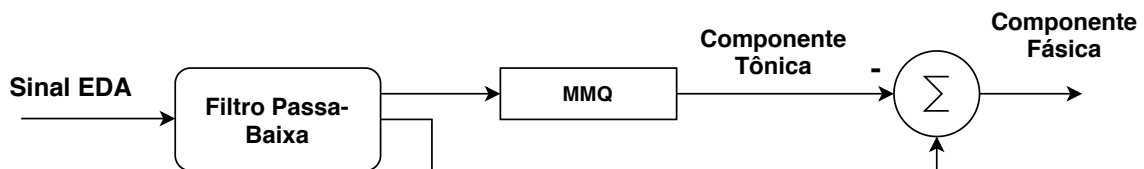
Figura 5: Diagrama de blocos do processo de separação do sinal de EDA em suas componentes física e tônica.
