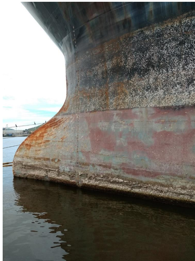
Figura 2 - Exemplo de incrustação em casco de navio
