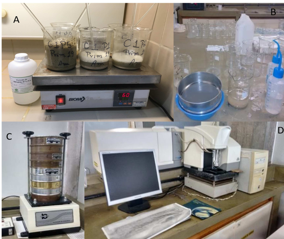
Figura 14 – Registro de algumas etapas da análise de sedimento: a) Oxidação das amostras; b) peneiramento úmido; c) conjunto de peneiras para separação de grãos e d) Malvern modelo Ms 2000
