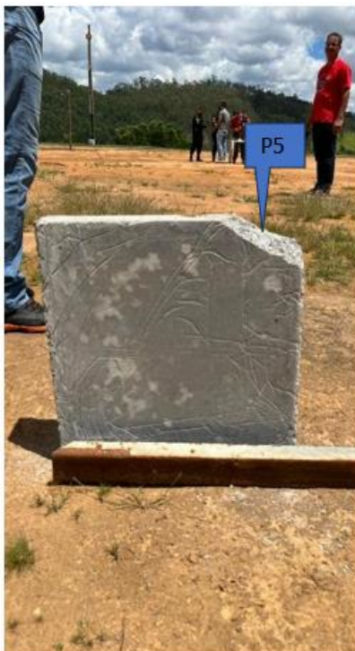
Figura 17 – Face CPPB oposta ao impacto balístico
