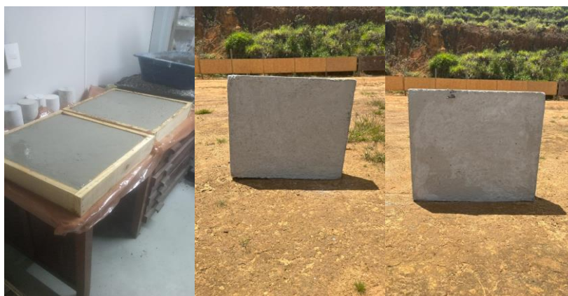
Figura 10 – Corpos de prova prismáticos
