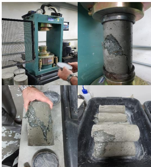
Figura 12 – Ensaio de compressão em prensa Solotest
