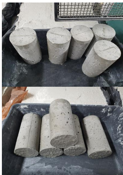
Figura 9 – Blocos CPC para ensaio de compressão
