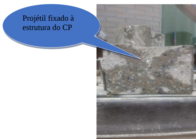
Figura 18 – Projétil fixado à estrutura do CPPB
