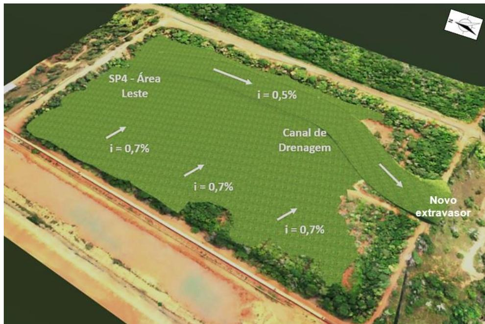
**Figura 15 – Superfície projetada do SP-4 Leste**
