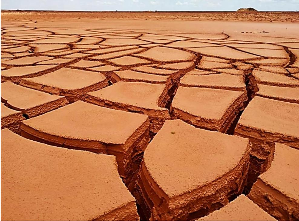
**Figura 11 – Rejeito após ciclo de disposição**
