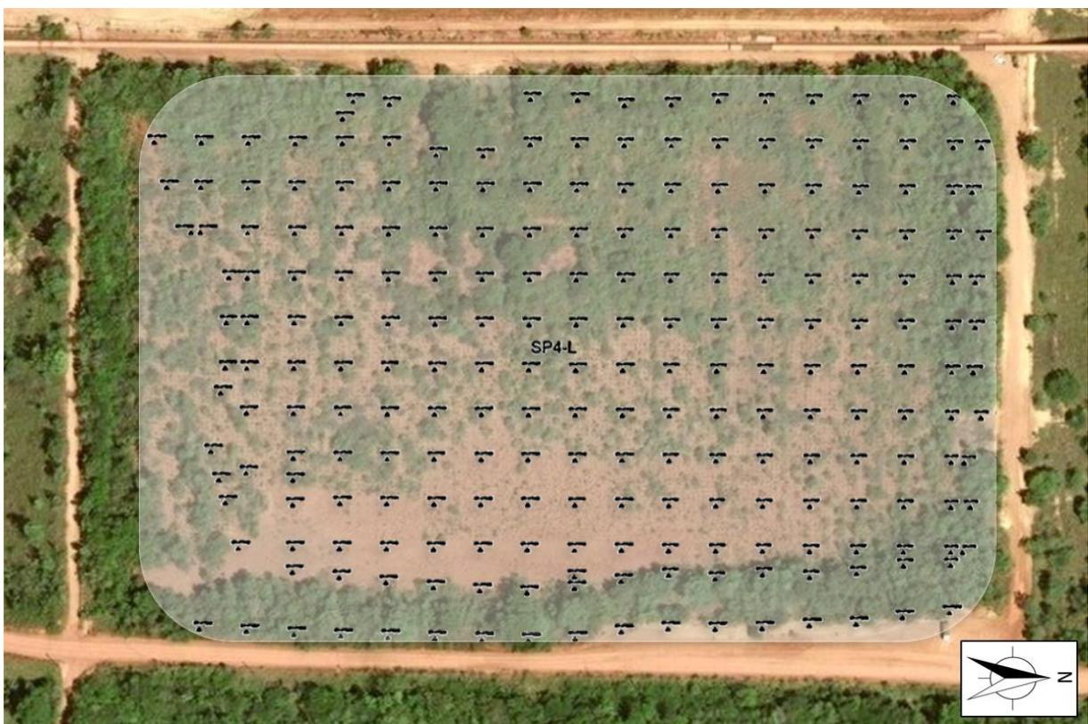
**Figura 21 – Malha de piquetes para monitoramento topográfico**
