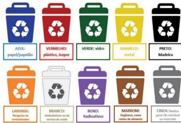
Figura 2 – Padrão de cores estabelecido na resolução CONAMA nº 275/2001 para diferentes tipos de resíduos sólidos
