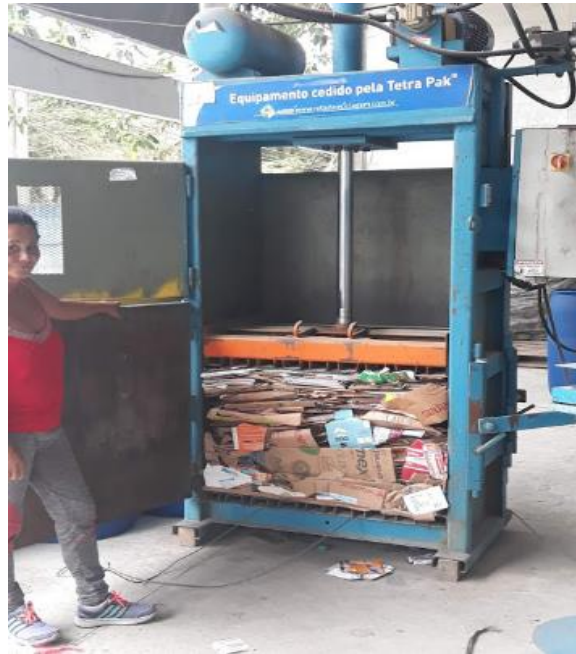
Figura 21 – Maquinário recuperado e cedido pela empresa Tetra Pack – Prensa Hidráulica
