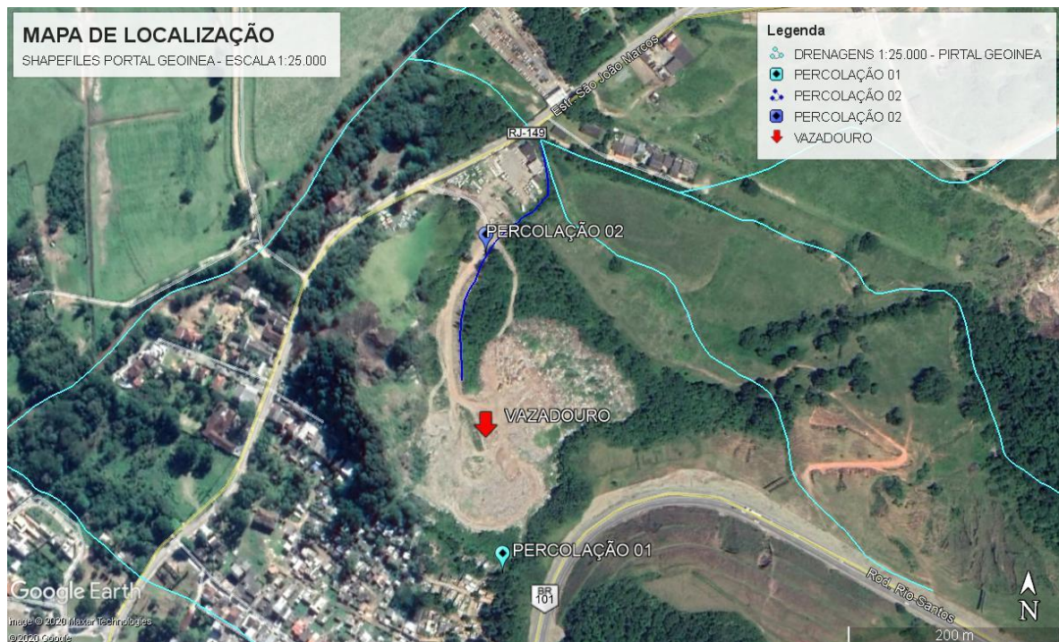
Figura 17 – Pontos de percolação de chorume (PERCOLAÇÃO 01 e 02) da área do antigo lixão de Mangaratiba
