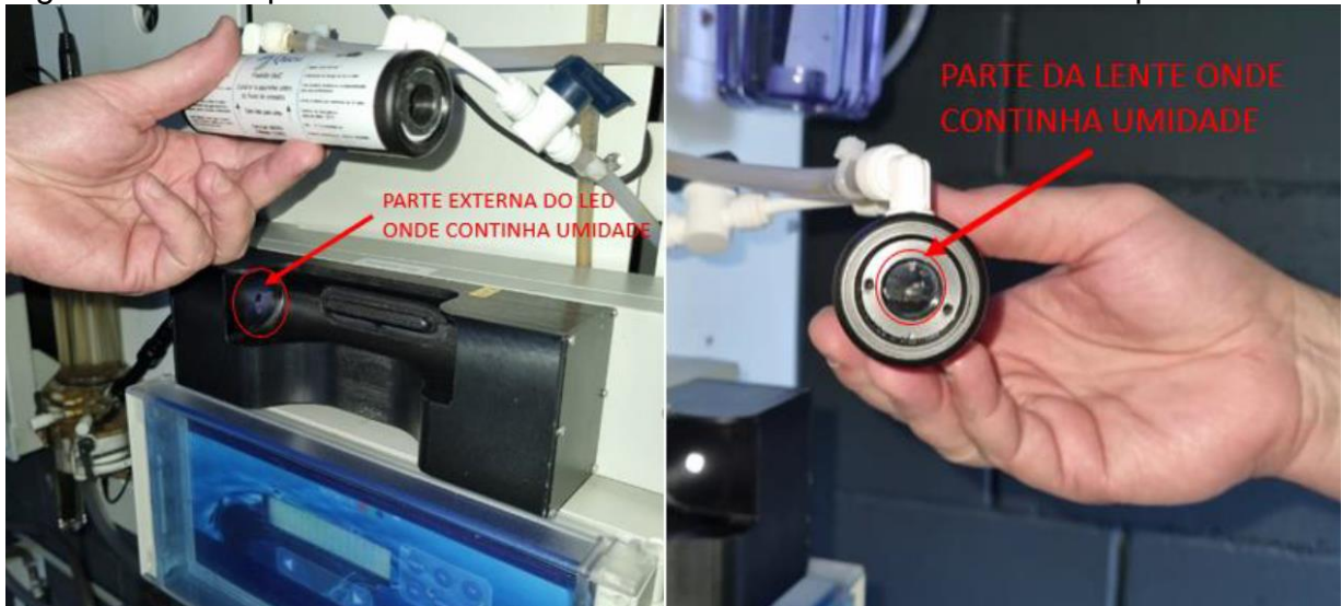
Figura 17 – Componente do sistema ótico do módulo de análise de cor aparente.
