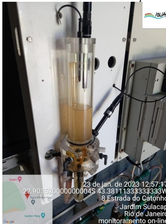
Figura 15 – Câmara de fluxo dos instrumentos de medição de cloro e pH.
