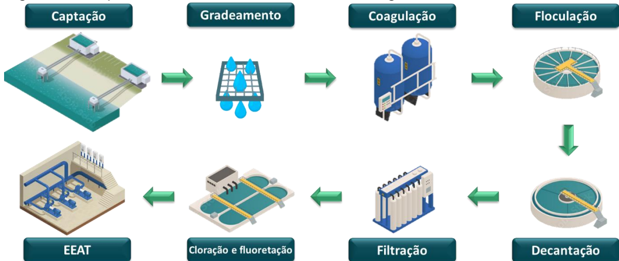
Figura 2 – Etapas do sistema de abastecimento de água
