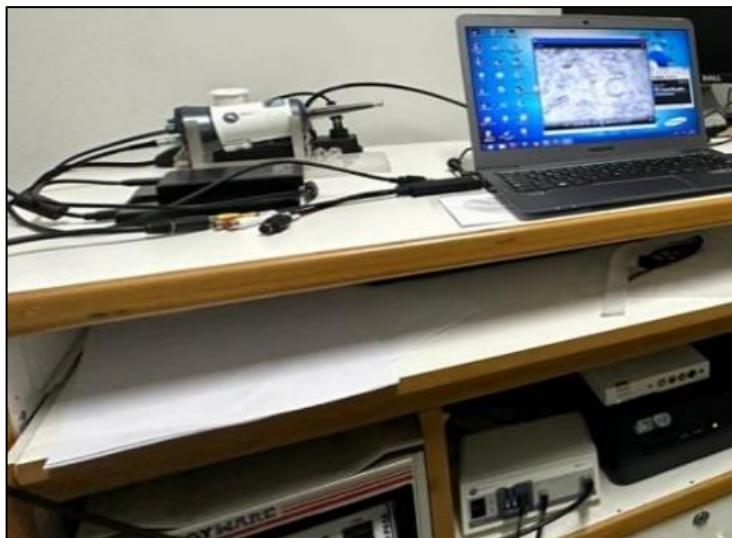
Figura 5 – Conexão da sonda com o sistema de captura de imagem
