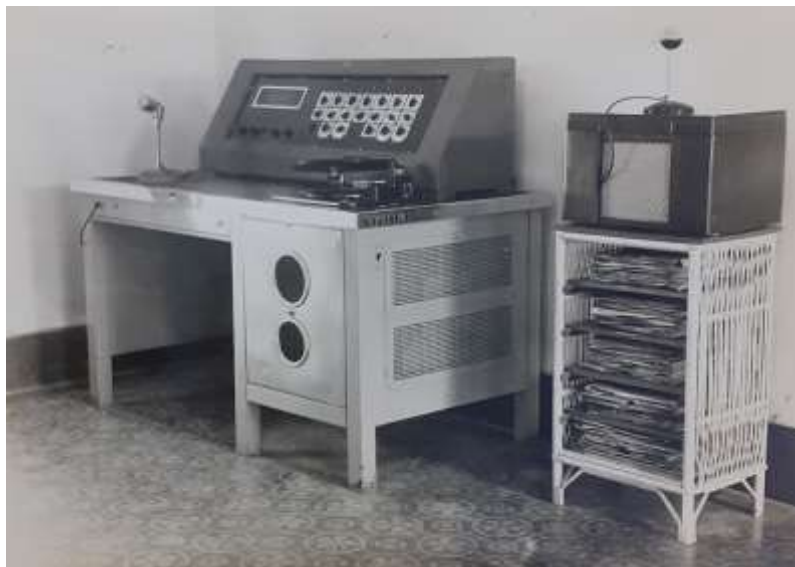
Figura 12. Mesa de comando do sistema de amplificação construída nas oficinas da Colônia.
