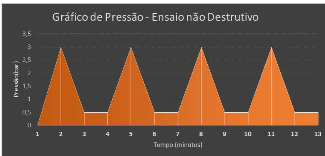
Fig. 18 – Representação gráfica do ensaio hidrostático não destrutivo
