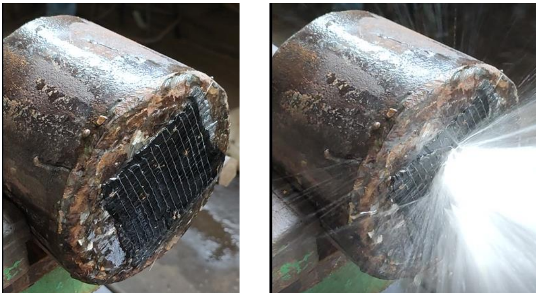
Fig. 17 – À esquerda, Ensaio Hidrostático de PRFC antes da ruptura, à direita, rompimento do composto em múltiplos pontos na área central.
