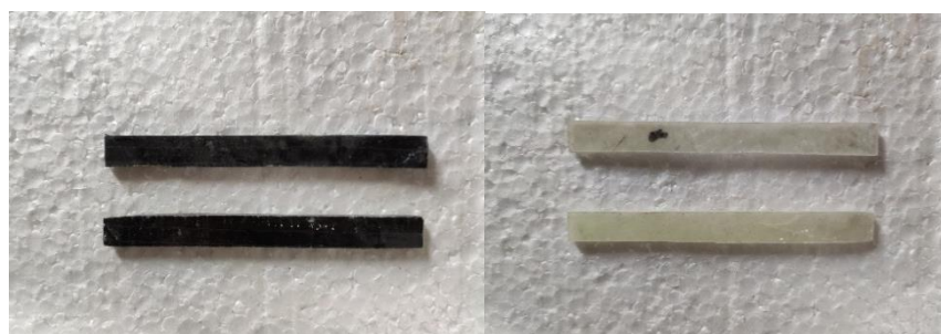
Figura 7 - Corpos de prova de ERFC, ERFV, PRFC e PRFV
