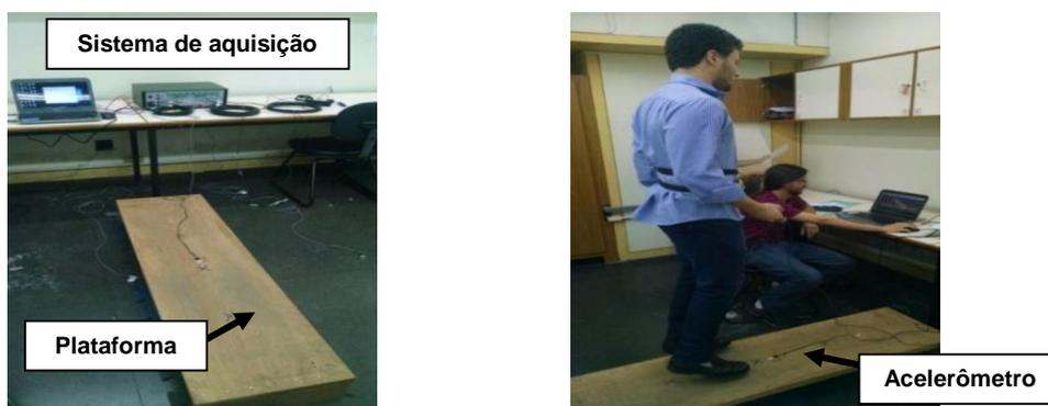
**Figura 19 - Experimento de saltos sobre uma plataforma [44]**
