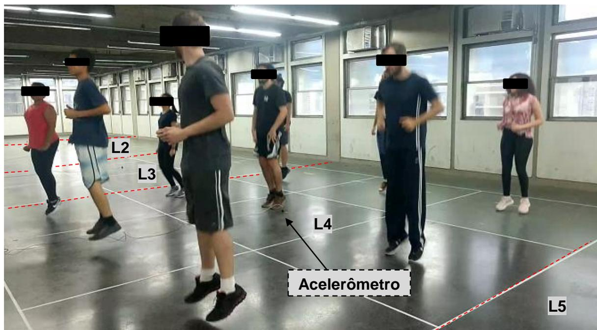
**Figura 126 - Modelo de carregamento VIII (9 Pessoas sobre a Laje L4)**
