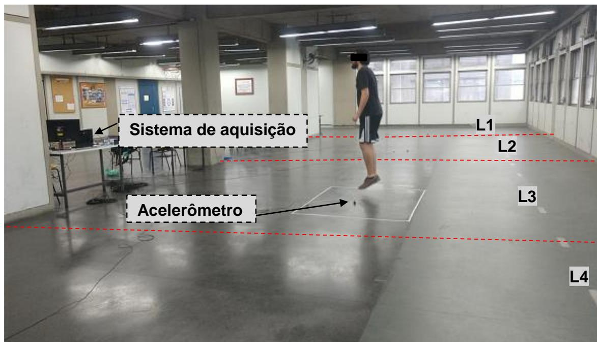
**Figura 113 - Modelo de carregamento I (1 Pessoa sobre a Laje L3)**
