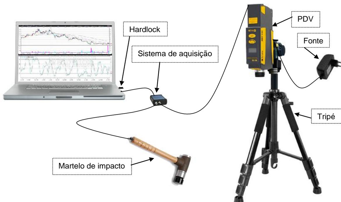
**Figura 97 - Equipamentos utilizados no Teste II (Catálogo de equipamentos)**
