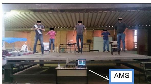
b) Saltos sobre o piso de concreto armado
