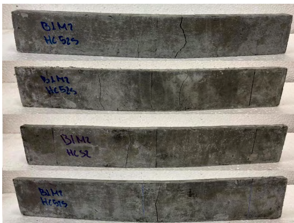
Figura 115 - Amostras M2 com 714 dias de idade e após ensaio de flexão.
