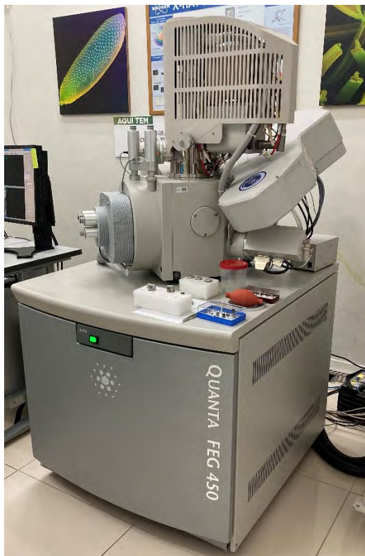
Figura 33 - Microscópio eletrônico quanta FEG 450 do CENANO-INT
