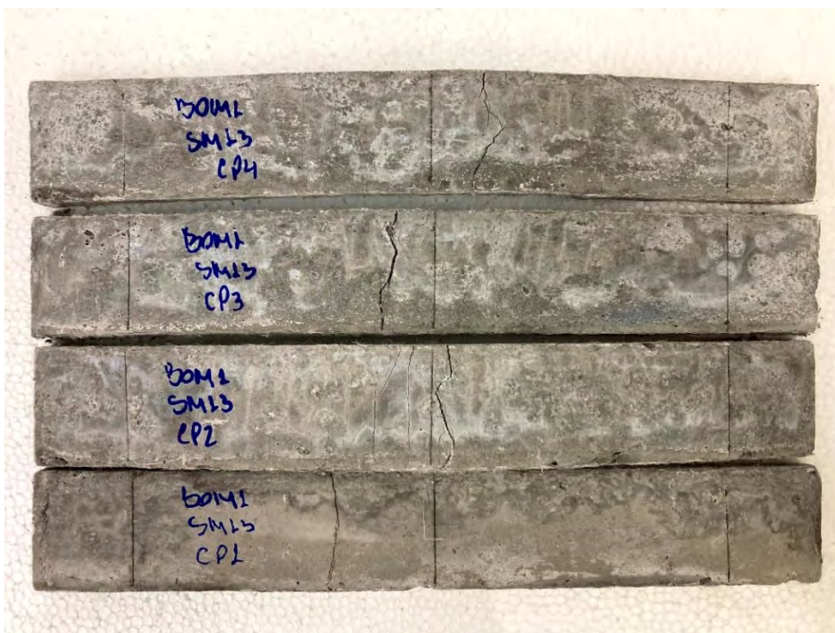
Figura 135 – Amostras M1 após 91 dias de envelhecimento em sulfato de magnésio
