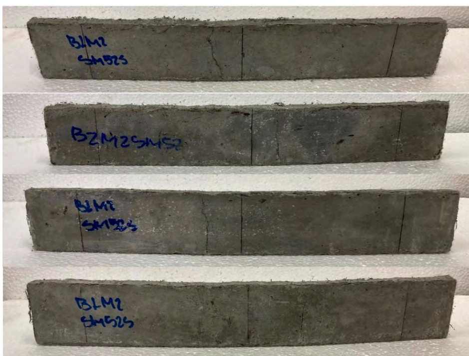
Figura 140 – Amostras M2 após 686 dias de envelhecimento em sulfato de magnésio
