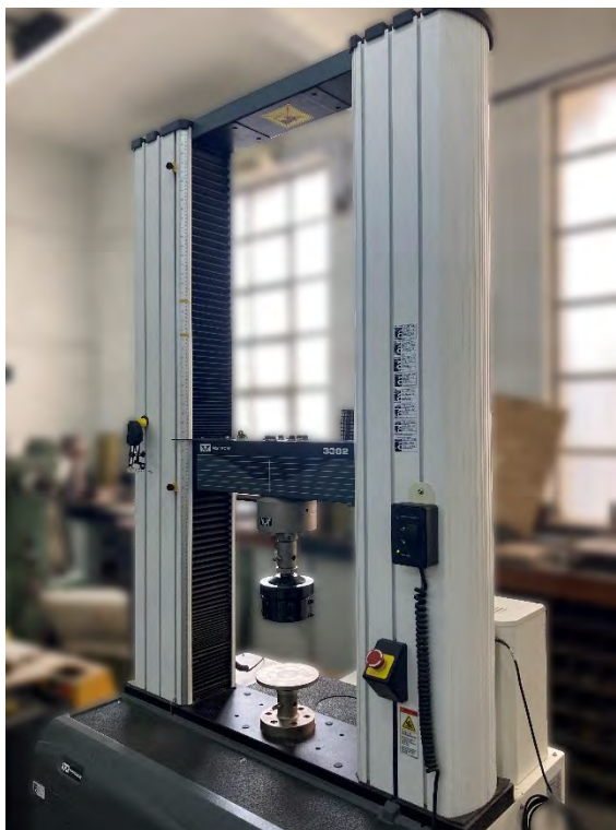
Figura 38 - Sistema internacional de ensaios Instron
