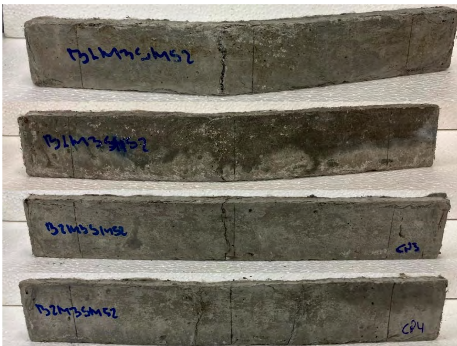
Figura 144 – Amostras M3 após 686 dias de envelhecimento em sulfato de magnésio
