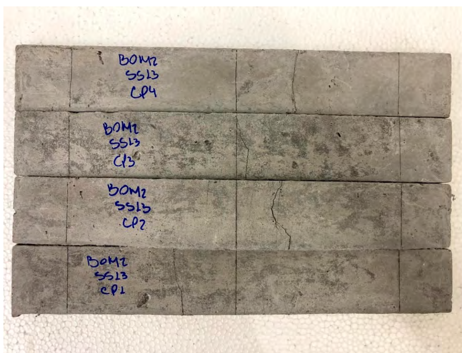
Figura 127 – Amostras M2 após 91 dias de envelhecimento em sulfato de sódio.
