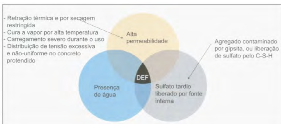
Figura 8 - Enfoque holístico para expansão e fissuração por formação de etringita tardia (Mehta e Monteiro, 2014, p. 164)
