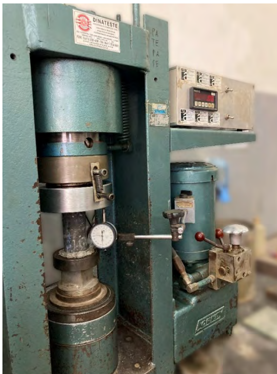
Figura 41 - Prensa hidráulica para ensaio de resistência à compressão com relógio comparador para controle da aplicação de deslocamento do pistão.
