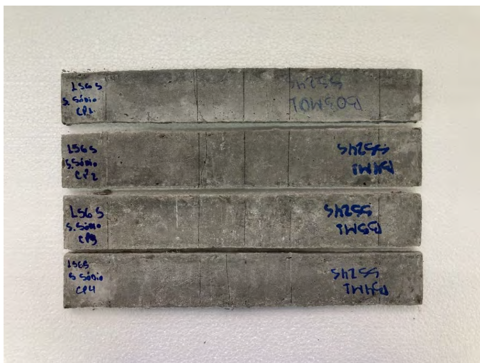
Figura 126 – Amostras M1 após 1092 dias de envelhecimento em sulfato de sódio.
