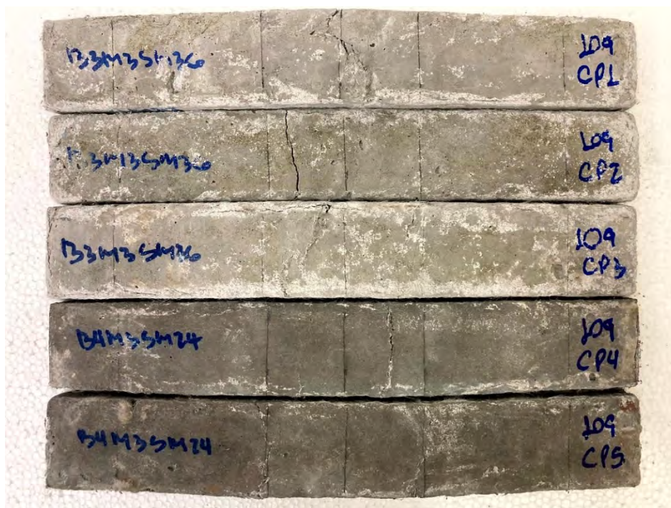
Figura 145 – Amostras M3 após 763 dias de envelhecimento em sulfato de magnésio
