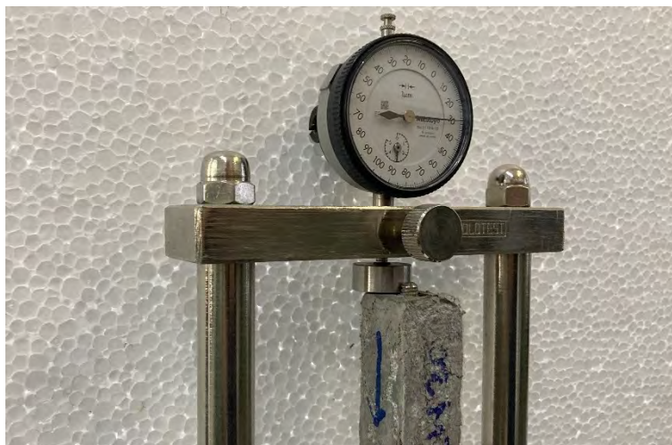
Figura 95 - Impossibilidade de leitura de expansão da amostra deteriorada.
