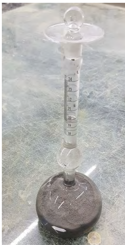
Figura 20 - Frasco de Le Chatelier com graduações de 0,05 cm 3
