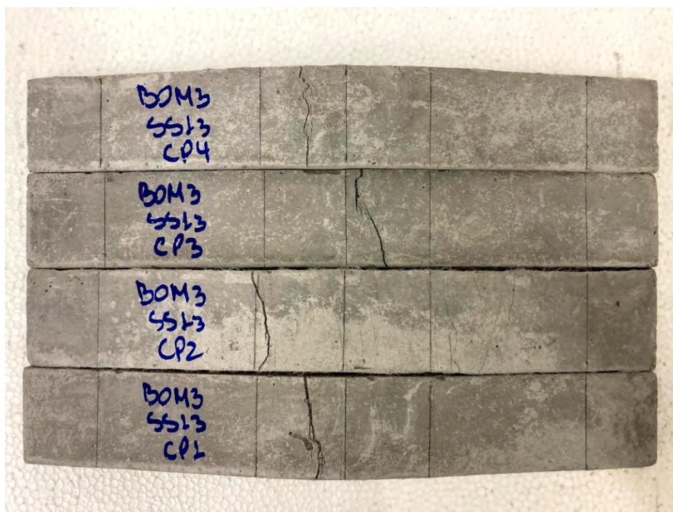
Figura 131 – Amostras M3 após 91 dias de envelhecimento em sulfato de sódio
