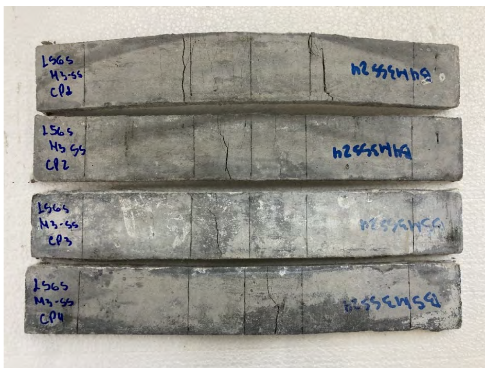
Figura 134 – Amostras M3 após 1092 dias de envelhecimento em sulfato de sódio
