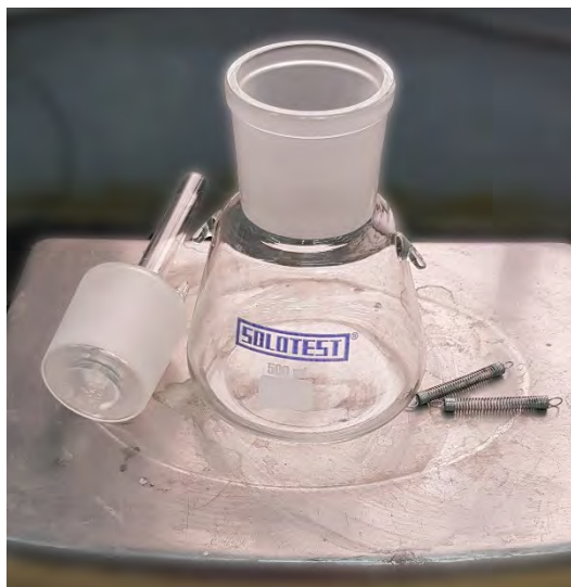
Figura 22 - Frasco aferido com capacidade de 500 cm 3
