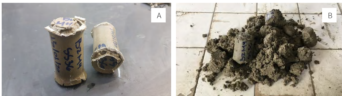
Figura 68 – Imagens com o aspecto das amostras da mistura M4 após a imersão em soluções de sulfato de sódio aos 161 dias (A) e 239 dias (b).
