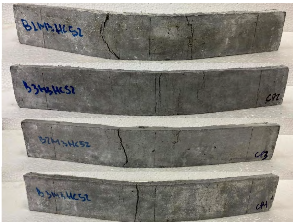
Figura 120 - Amostras M3 com 714 dias de idade e após ensaio de flexão.
