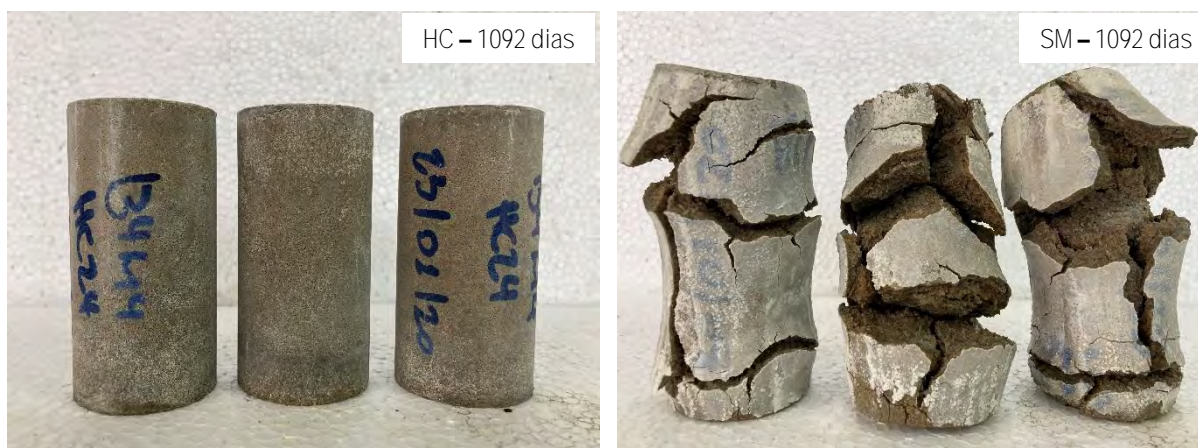
Figura 90 – Amostras cilíndricas da mistura M4 após 1120 dias em hidratação com hidróxido de cálcio e 1092 dias de imersão em sulfato de magnésio.
