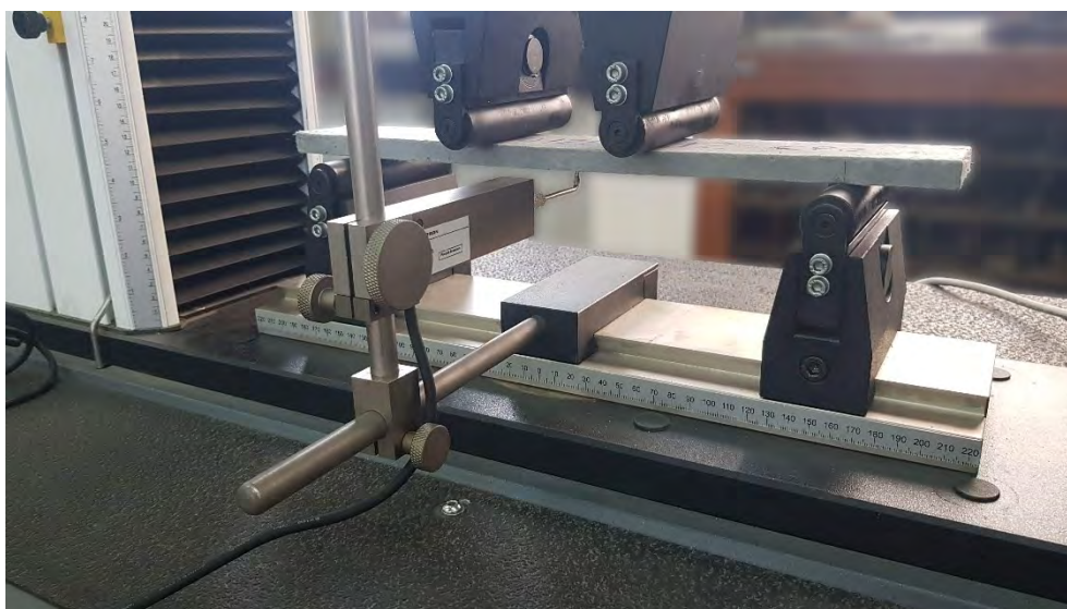
Figura 44 - Configuração do ensaio de flexão.
