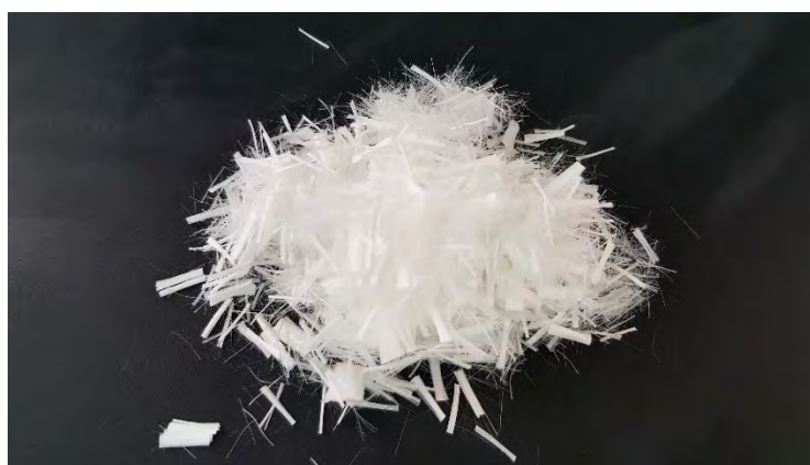
Figura 25 - Fibras de PVA utilizadas na confecção das amostras. Comprimento de 12 mm e espessura de 3,9 mm.
