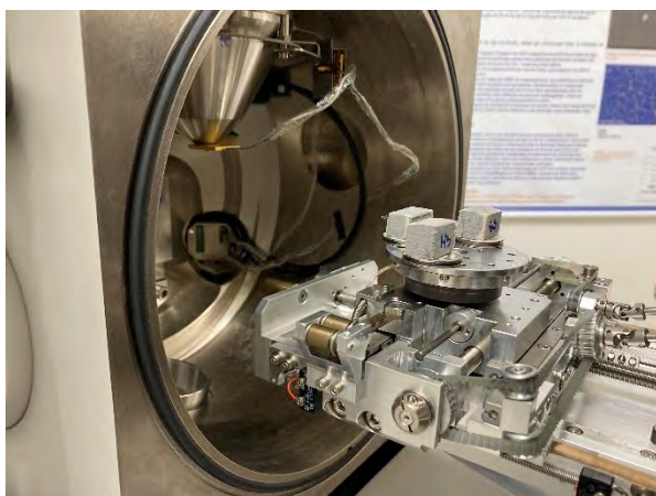
Figura 37 - Alocação das amostras na câmara de ensaio
