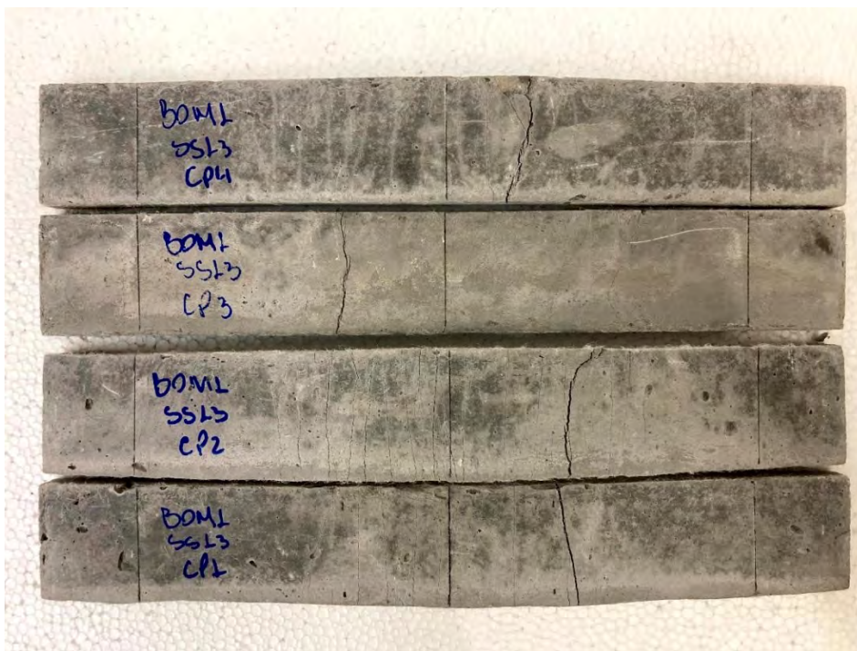
Figura 123 – Amostras M1 após 91 dias de envelhecimento em sulfato de sódio.
