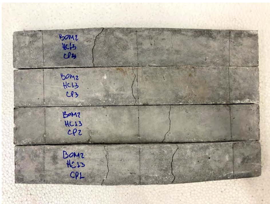
Figura 114 - Amostras M2 com 119 dias de idade e após ensaio de flexão.
