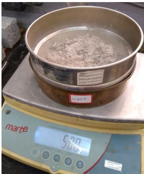
Figura 21 - Peneira de 75 \mu\text{m} e pesagem da amostra utilizada no ensaio
