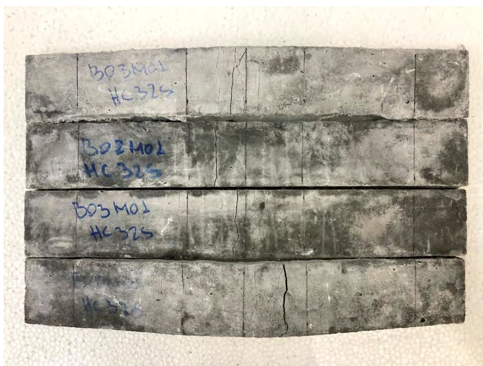
Figura 111 – Amostras M1 aos 791 dias de idade e após ensaio de flexão.
