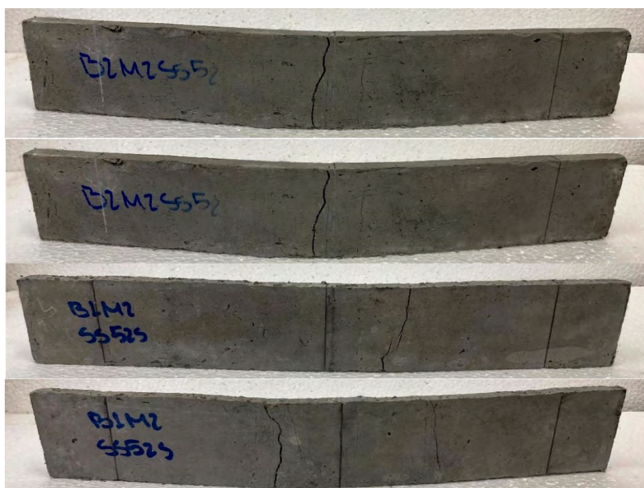
Figura 128 – Amostras M2 após 686 dias de envelhecimento em sulfato de sódio
