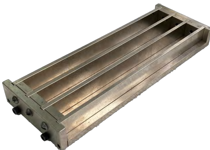
Figura 31 - Molde metálico de baixa rugosidade utilizados para confecção das amostras prismáticas.
