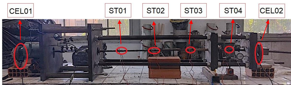
Figura 35 – Arranjo de ensaio e instrumentação para protensão da cordoalha da Amostra 2
