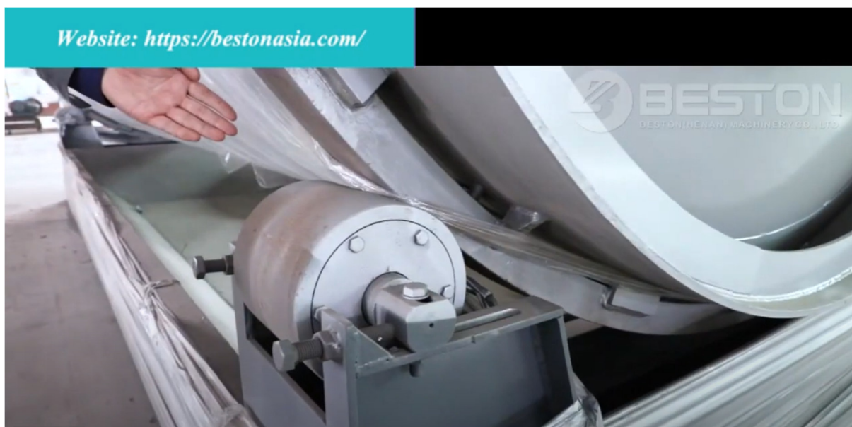
Foto 19 - Detalhe mostrando rolo e anel do reator
