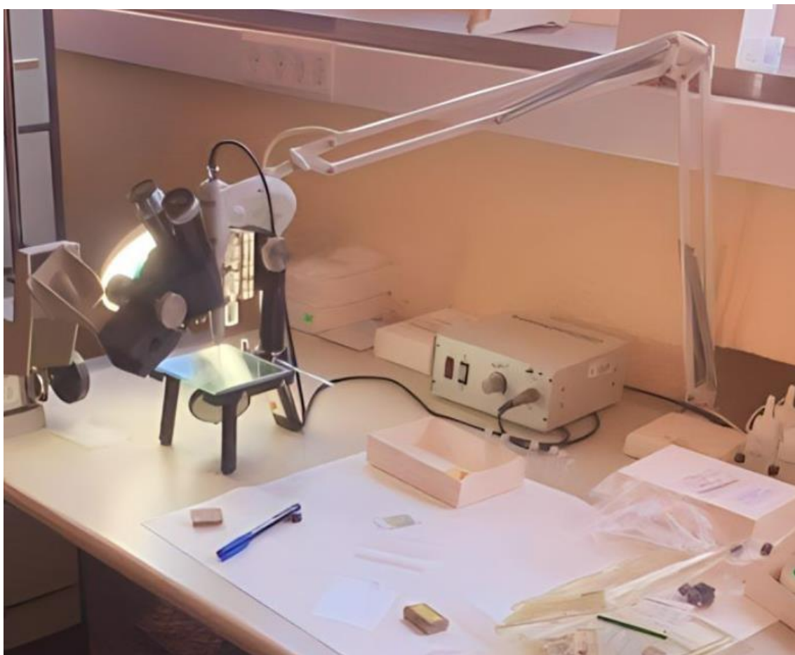
Figura 52. Sistema “microdrill” um sistema de microperfuração montado em microscópio binocular para a microperfuração Universidad Complutense de Madrid
