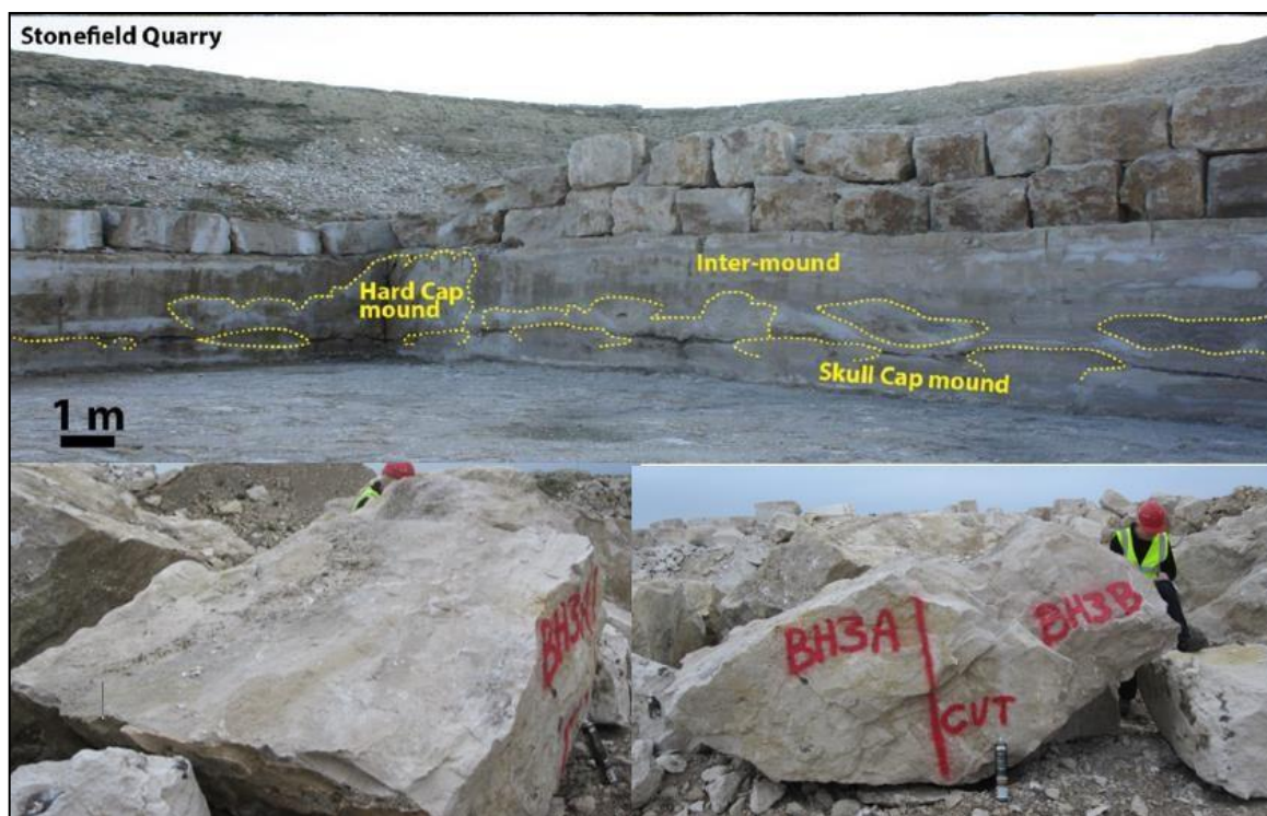
Figura 33. Pedreira com operação de extração de calcário em Purbeck área de Dorset de onde os blocos foram provenientes.
