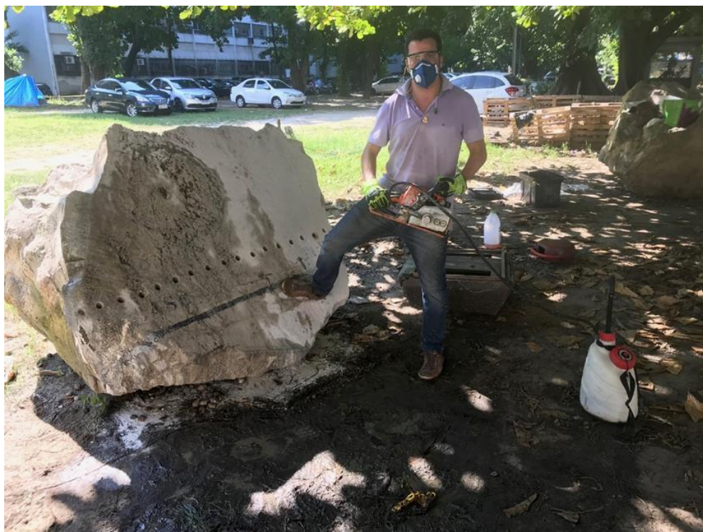
Figura 35. Operação de extração dos testemunhos com perfurador STIHL.
