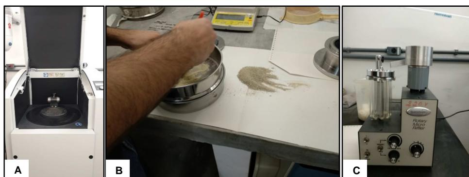
Legenda:(A) Moinho de discos, (B) Peneiramento em peneira de abertura de 106  $\mu\text{m}$  e maceração manual com o *gral* e o pistilo de ágata e (C) Quarteamento no quarteador mecânico modelo *Rotary Micro Riffer*.
