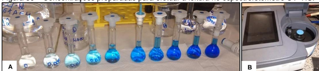
Legenda: (A) Concentrações efetuadas em balões de 10 mL e (B) Espectrofotômetro UV-VIS.
