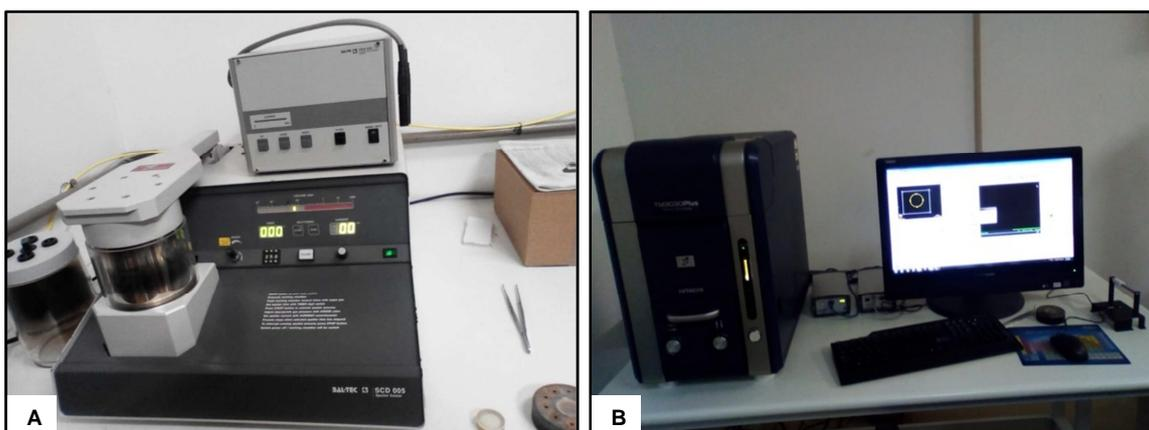
Legenda: (A) Metalização em prata e (B) Microscópio eletrônico de varredura (TM3030Plus).
