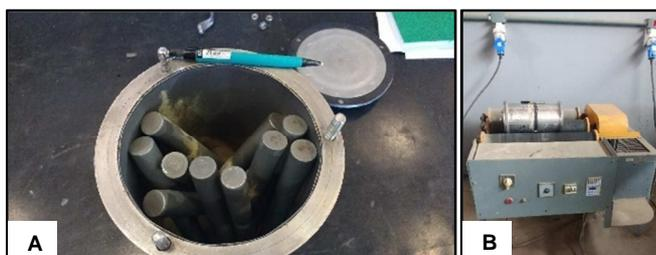
Legenda: (A) Moinho de barras a úmido utilizado na moagem da palygorskita (B) Moinho de barras submetido à unidade motora.
