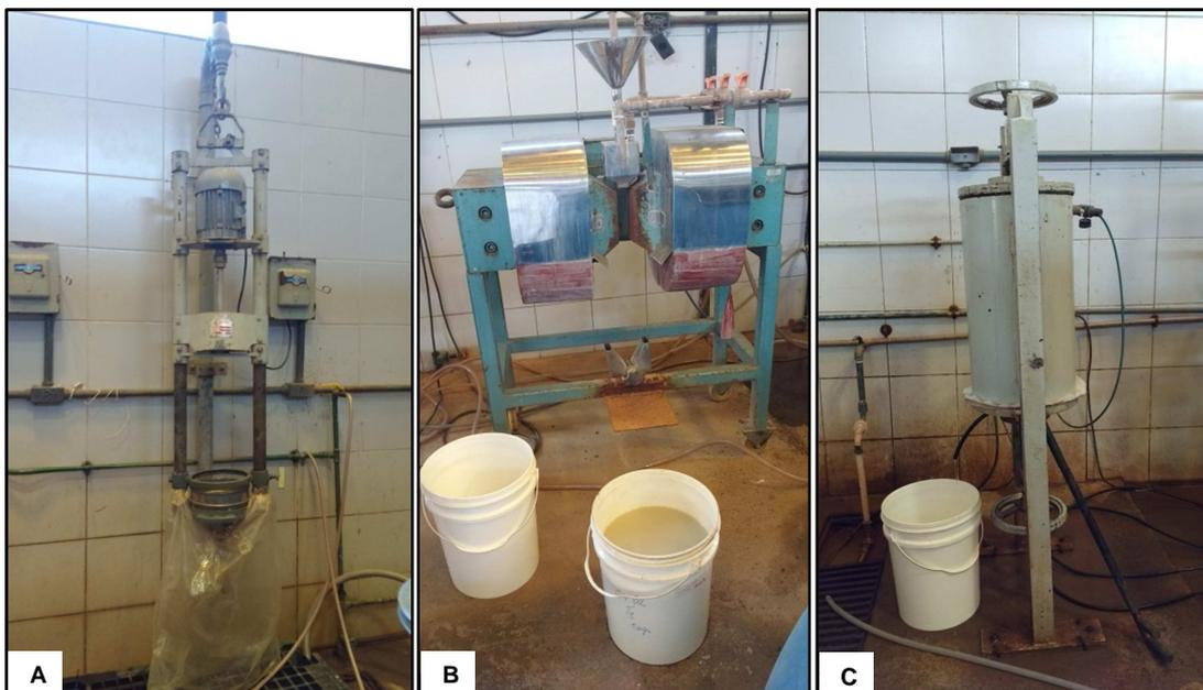
Legenda: (A) peneirador vibratório, (B) separador magnético BOXMAG Rapid e (C) Filtro Prensa.
