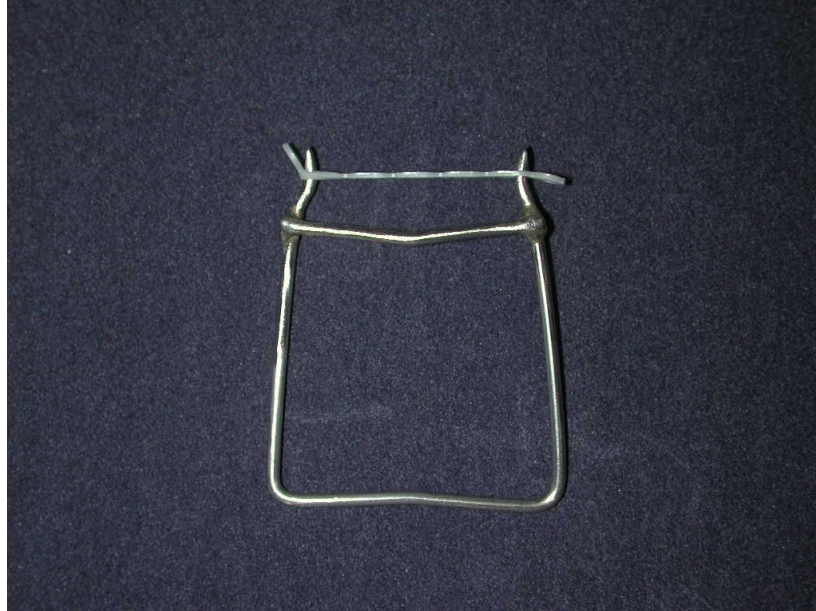
Figura 6- Dispositivo em “U” utilizado para a transferência dos elásticos, apresentando elastômero distendido.
