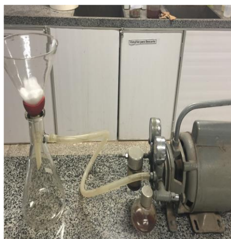
Figura 4 - Bomba suctora para filtração
