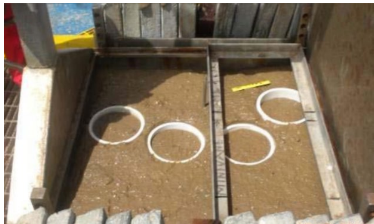
Figura 3 - Sub-amostragem realizada no Box Corer (Oceanology International, 2020)
