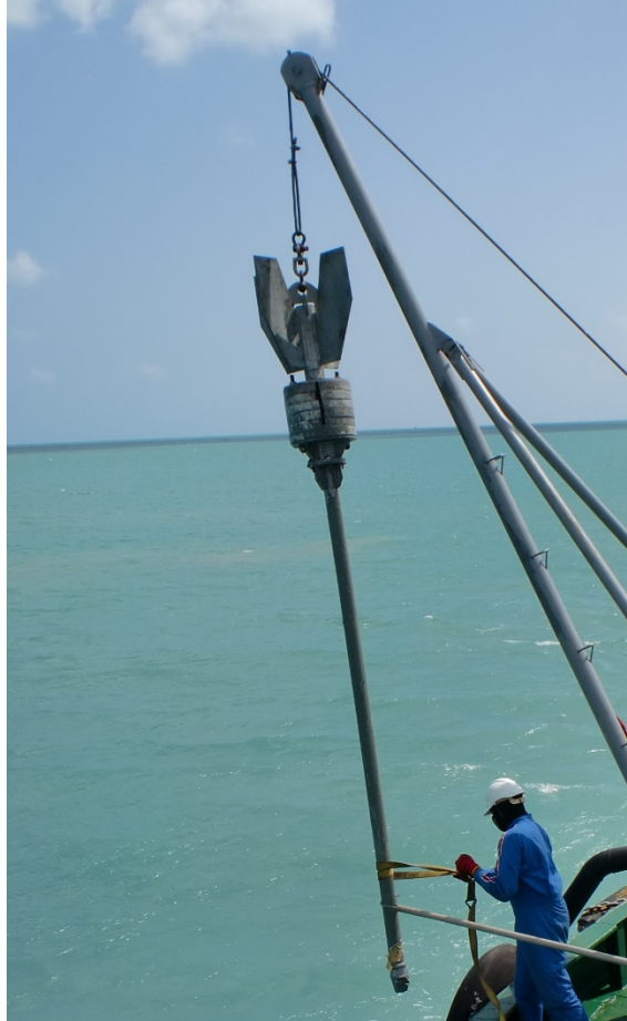
Figura 4 - Amostrador tipo Gravity Corer (Hydro Mappers, 2021).
