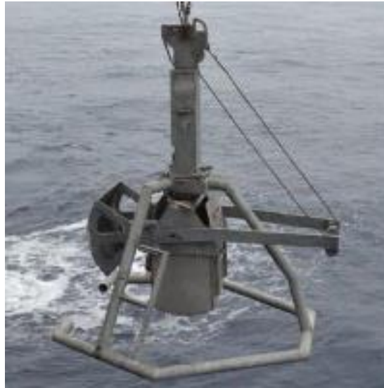
Figura 2 - Amostrador tipo Box Corer (Benthic Solutions, 2020)
