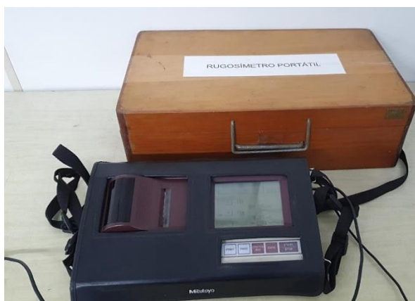
Figura 20 - Rugosímetro portátil utilizado para medir rugosidade das superfícies
