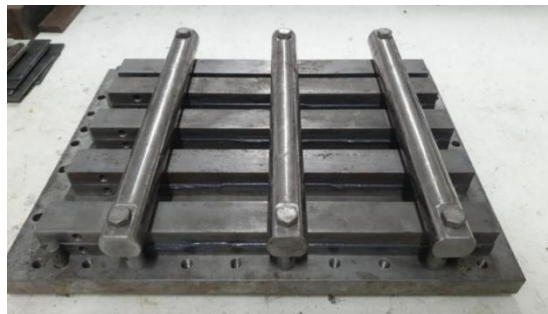
Figura 26 - Molde utilizado na união dos corpos de prova
