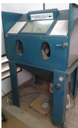
Figura 16 - Equipamento COTIJATO utilizado no procedimento de jateamento dos CPs
