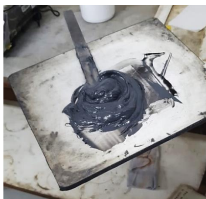
Figura 24 - Processo de mistura dos componentes do adesivo
