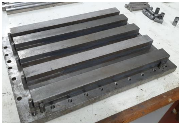
Figura 27 - Remoção das juntas do molde
