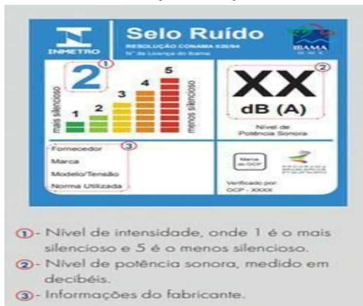
Figura 3 - Modelo do selo utilizado em eletrodomésticos: liquidificadores, secadores de cabelo e aspiradores de pó.
