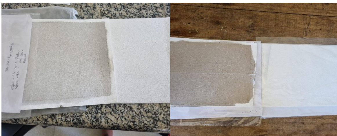
Figura 37 – Fotos ilustrativas da comparação dos filtros do aparelho Hi Vol antes e após sua utilização
