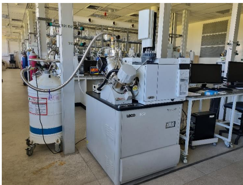
Figura 34 – Foto ilustrativa do instrumento de cromatografia gasosa bidimensional (aparelho GC×GC-TOFMS) no LADETC/UFRJ
