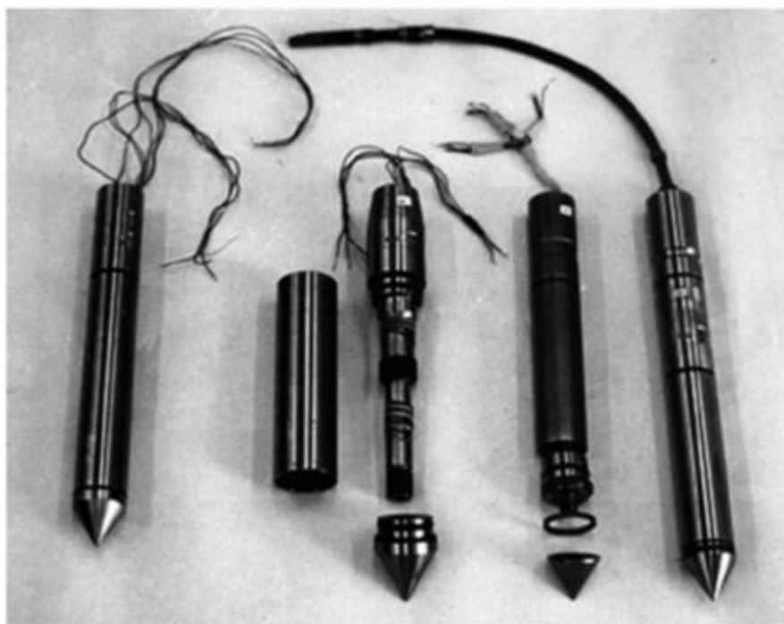
Figura 13 - Principais componentes do equipamento (Schnaid e Odebrecht 2012).
