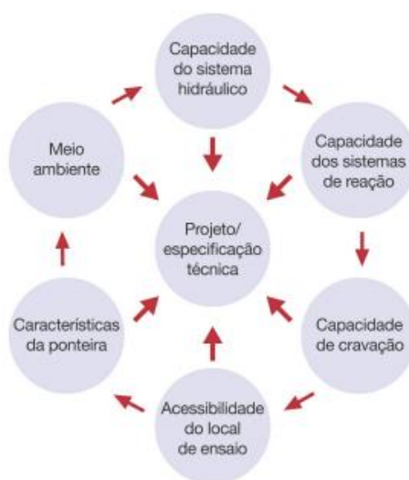
Figura 20 - Esquema de interação na escolha do equipamento (Schnaid e Odebrecht 2012).
