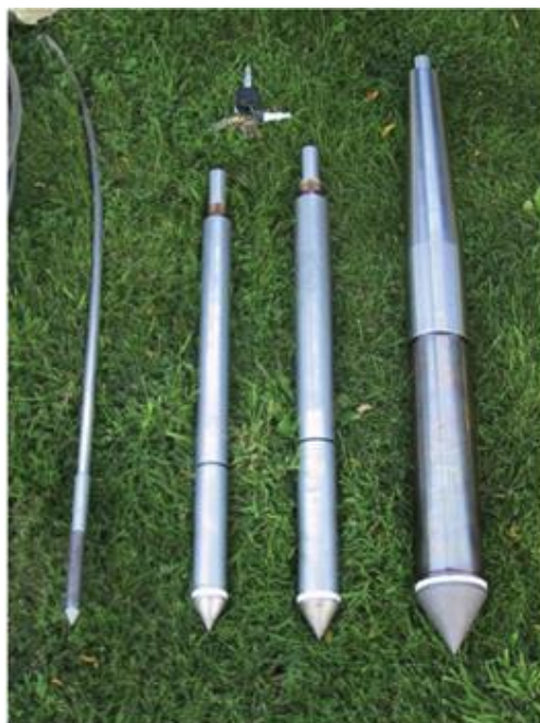
Figura 14 - Tipos de ponteiros (respectivamente: 2 cm 2 , 10 cm 2 , 15 cm 2 , 40 cm 2 ) (Robertson 2006).
