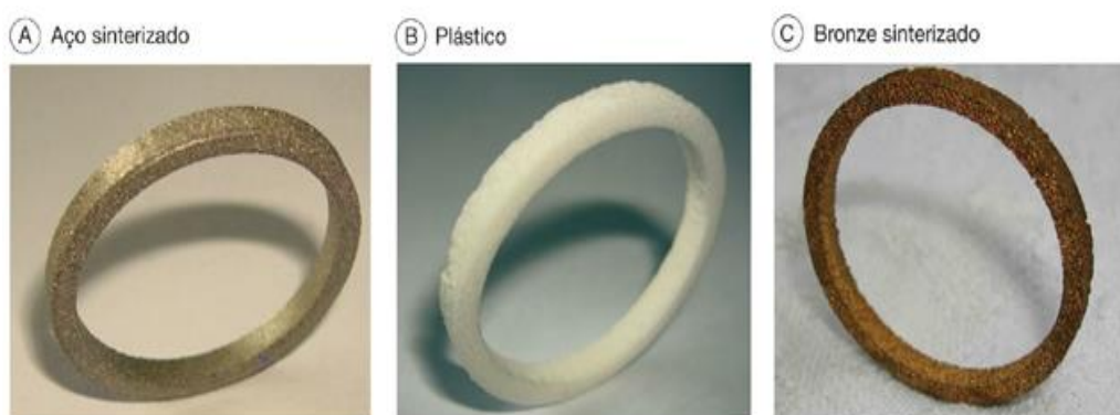
Figura 17 -Tipos de elemento filtrante (Schnaid e Odebrecht 2012).
