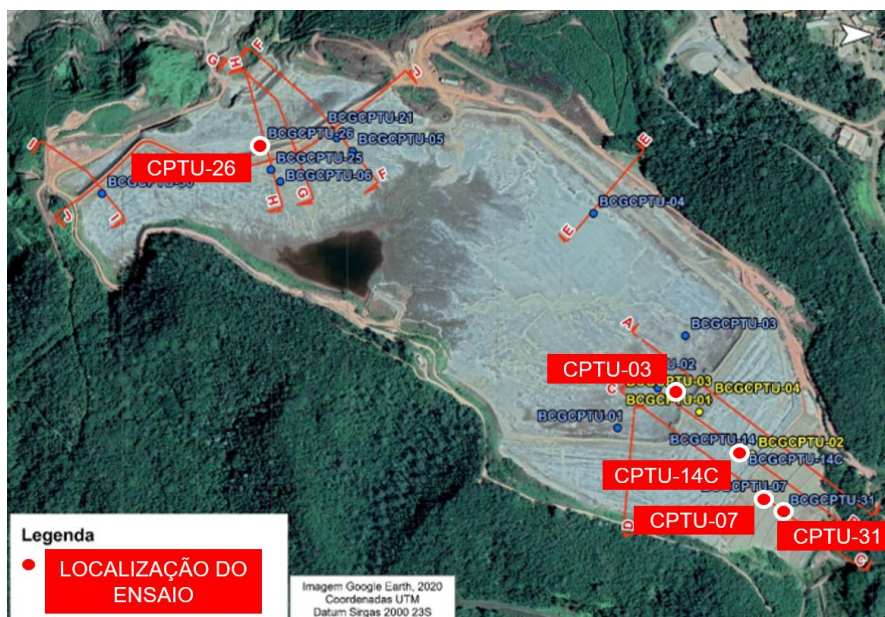
Figura 25 – Localização dos Ensaios CPTu da Barragem 1
