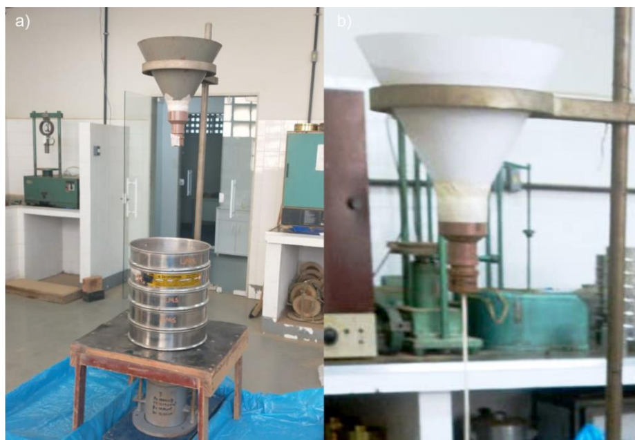
Figura 51 - Pluviação com funil elaborado usando conexões de PVC: a) vista geral; b) detalhe de uma ponteira de funil com furo de 10mm durante a pluviação.
