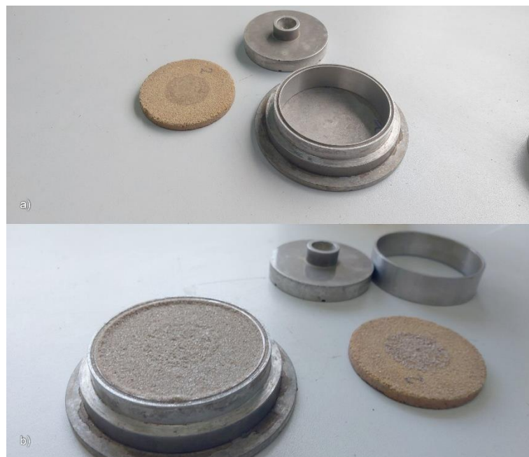
Figura 70 - a) Detalhe do anel, top cap e pedra porosa; b) conjunto após um dos ensaios.
