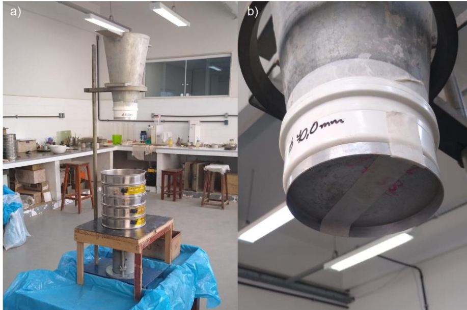
Figura 52 - Pluviação usando cone de slump test como funil: a) vista geral; b) detalhe do cap de PVC acoplado ao funil.
