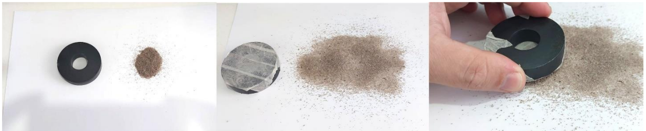
Figura 45 - Verificação expedita das propriedades ferromagnéticas da amostra.
