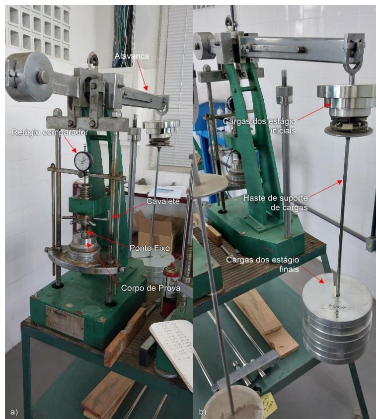
Figura 68 - Prensa de adensamento: a) vista frontal; b) vista posterior.
