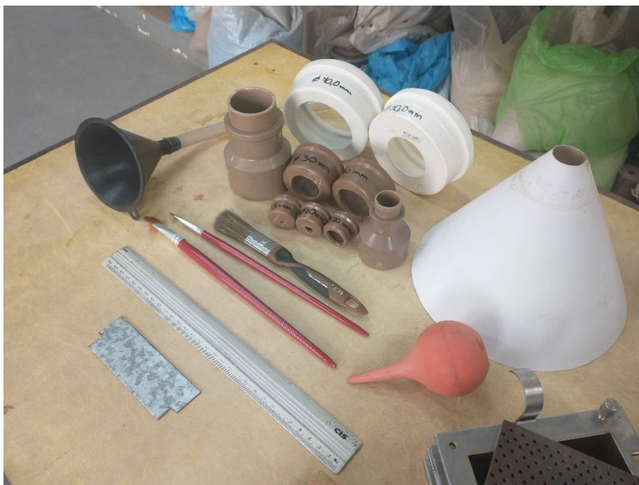
Figura 53 - Detalhe das conexões de PVC utilizadas para montar os funis.
