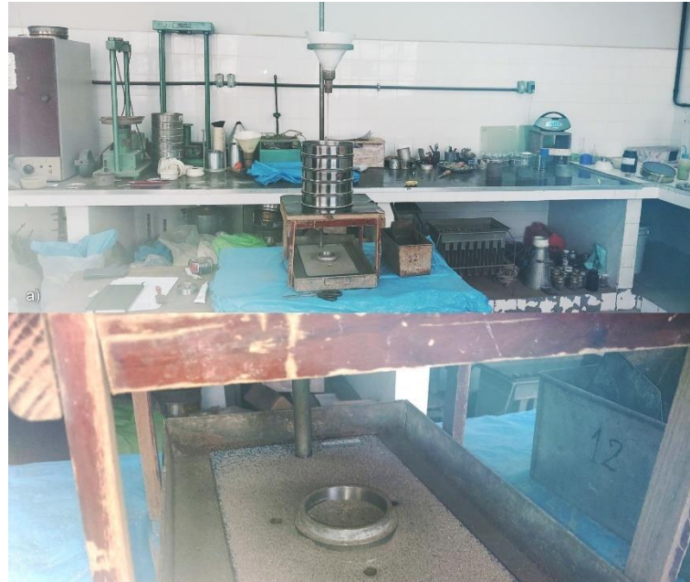
Figura 69 - a) Processo de pluviação para moldagem dos corpos de prova; b) Detalhe do anel sob pluviação.
