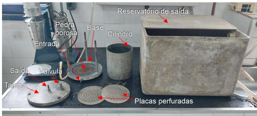
Figura 66 - Partes do permeâmetro.
