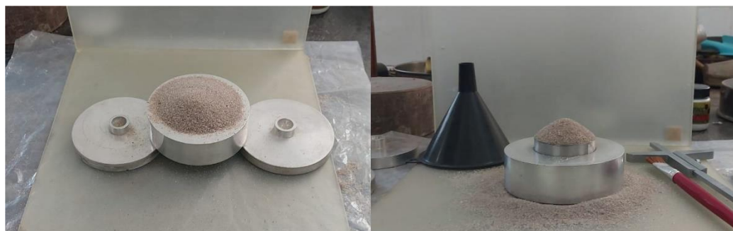
Figura 65 - Lançamento de areia e conformação final da pilha nos anéis de diâmetro d_1 = 53,9 mm.
