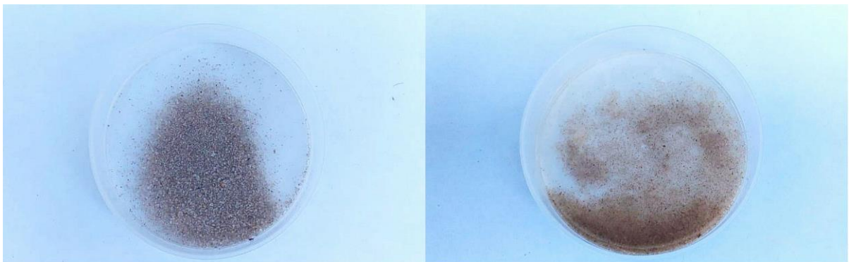
Figura 46 - Imersão de uma pequena amostra em HCl, não se verificou reação.
