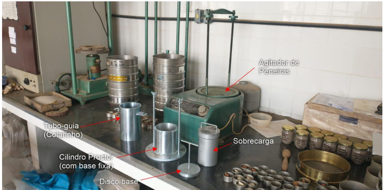
Figura 49 - Equipamentos empregados para a realização do ensaio segundo o Método B da NBR 16843.
