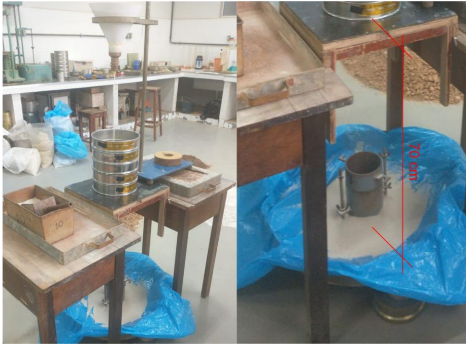
Figura 54 - Ensaio de pluviação preliminar, realizado com altura de queda de 70cm.
