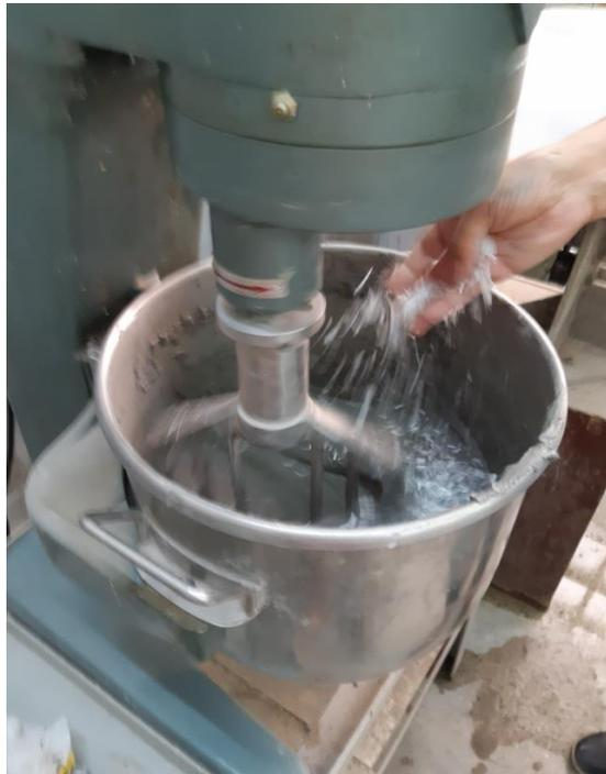
Figura 46 – Aplicação das fibras de PVA na matriz de cimento
