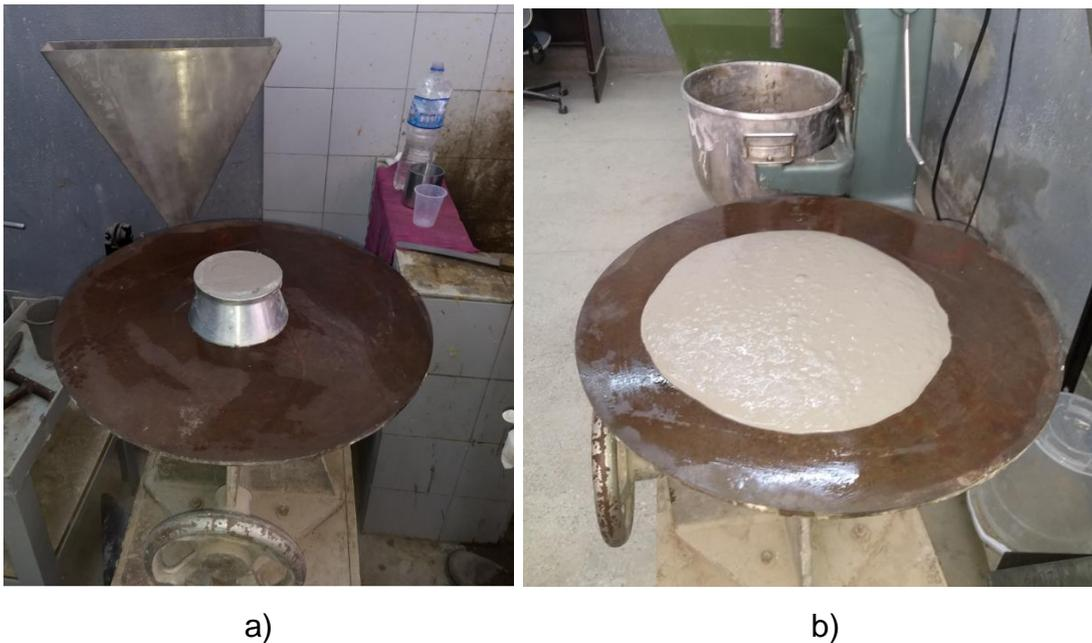
Figura 47 –a) Mesa para índice de consistência; b) Argamassa ao final do ensaio
