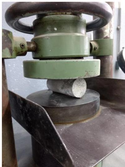
Figura 57 – Ensaio de tração por compressão diametral das argamassas de reparo.
