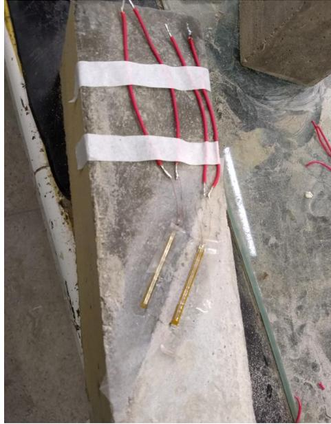
Figura 69 - Extensômetro no prisma composto
