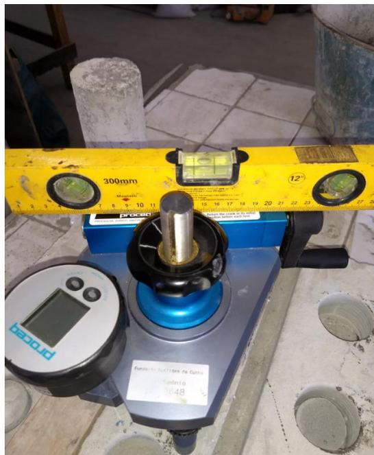
Figura 67 – Nivelamento do equipamento
