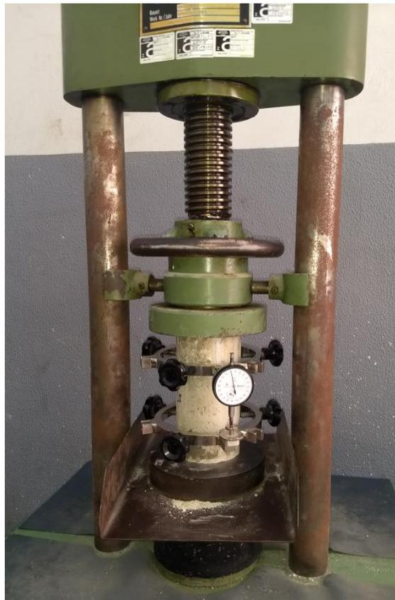
Figura 36- Ensaio de módulo de elasticidade
