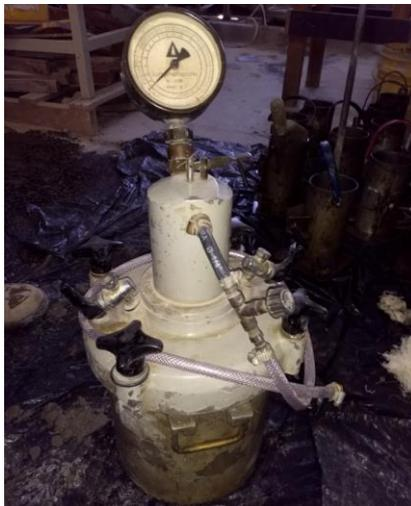
Figura 32 - Método pressométrico – Aparelho utilizado
