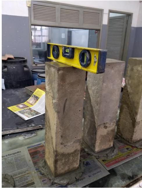
Figura 59 – Capeamento dos prismas
