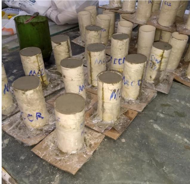
Figura 54 - Moldes dos corpos de prova após preenchimento da argamassa
