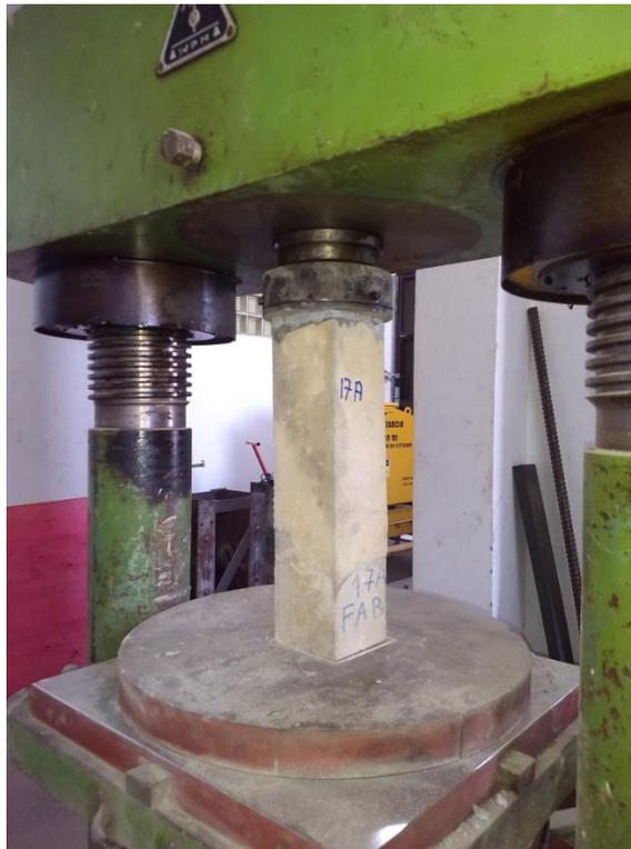
Figura 58 – Prensa utilizada no ensaio do prisma composto
