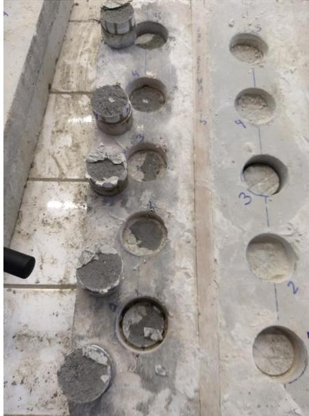
Figura 68 – Pastilhas rompidas após o ensaio
