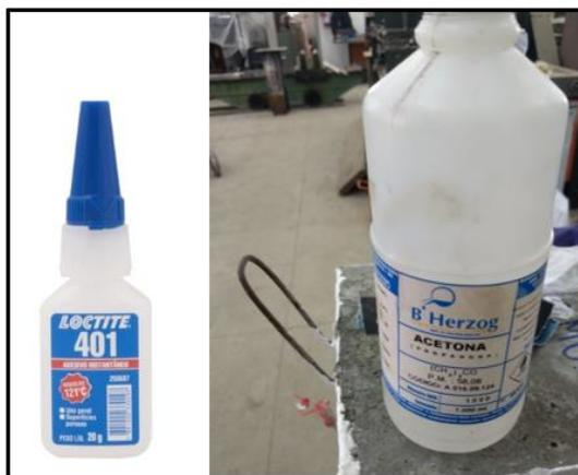
Figura 70 – Materiais utilizados para colagem do extensômetro
