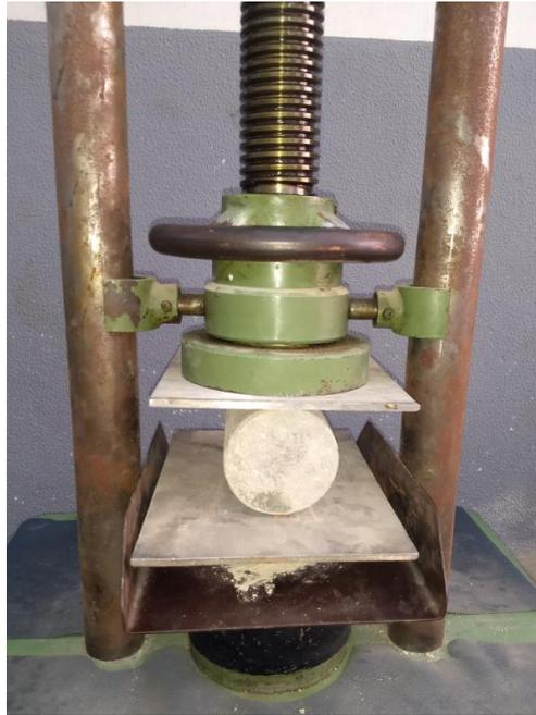
Figura 37 – Ensaio de tração por compressão diametral
