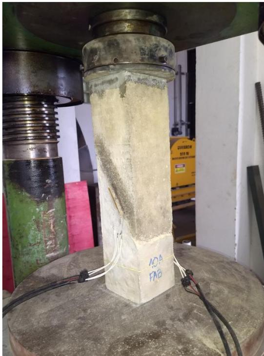
Figura 71 – Prisma composto com extensômetro
