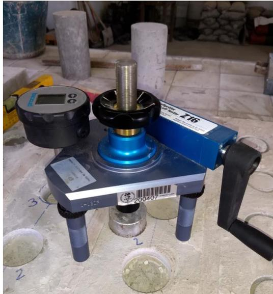
Figura 66 – Equipamento utilizado para o ensaio de arrancamento
