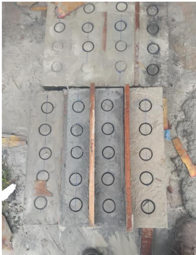
Figura 64 – Placas após a carotagem
