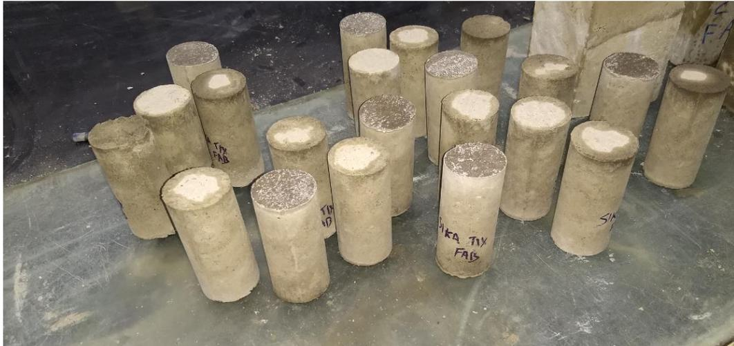
Figura 55 – Corpos de prova após a desforma
