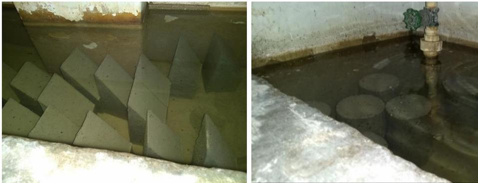
Figura 33 – Cura úmida dos corpos de prova
