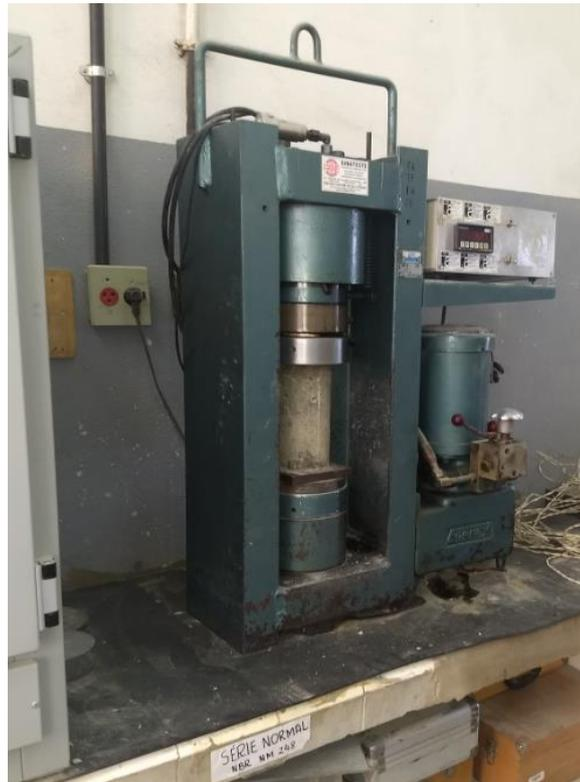
Figura 35 – Ensaio de compressão
