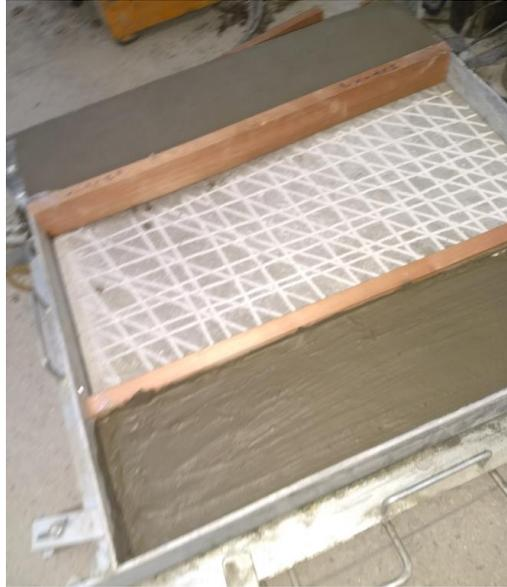
Figura 52 – Ponte de Aderência na Placa
