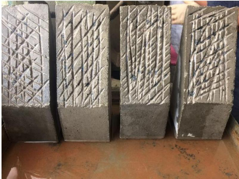
Figura 40 - Saturação da superfície (prisma composto)
