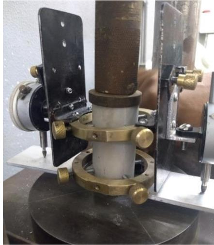
Figura 56- Ensaio do módulo de elasticidade das argamassas de reparo
