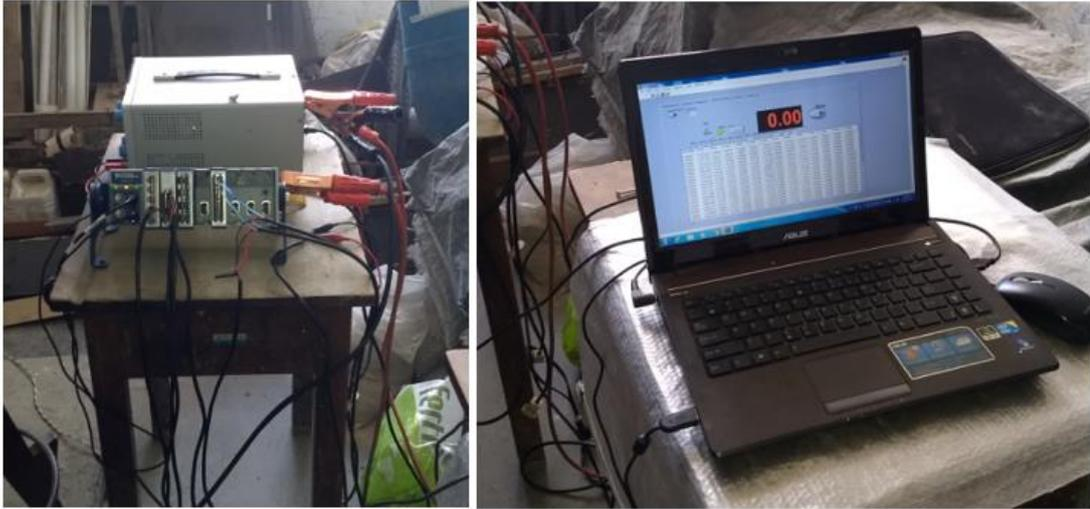
Figura 72 – Maquinário utilizado para leitura dos extensômetros
