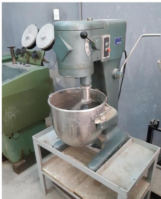
Figura 44 – Argamassadeira utilizada na preparação das argamassas de reparo
