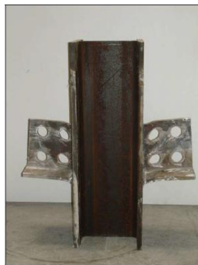
b) Plastificação do conector
