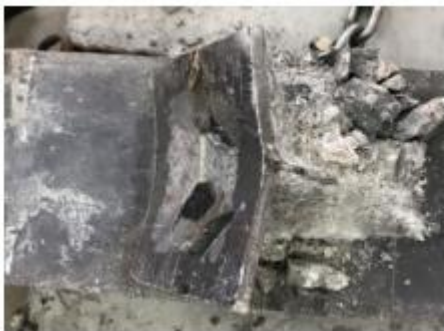
Figura 32 – Plastificação da mesa do conector TP45 (ASSUNÇÃO, 2018)
