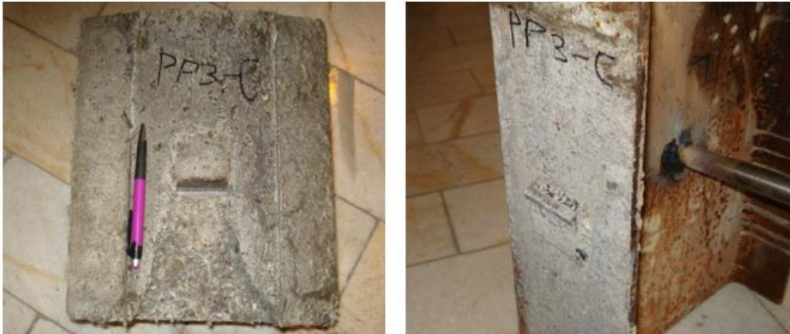
Figura 13 – Modo de ruptura do conector (MALEKI e BAGHERI, 2008)
