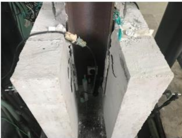
Figura 31 – Ruptura da laje de concreto no ensaio do TP45 (ASSUNÇÃO, 2018)
