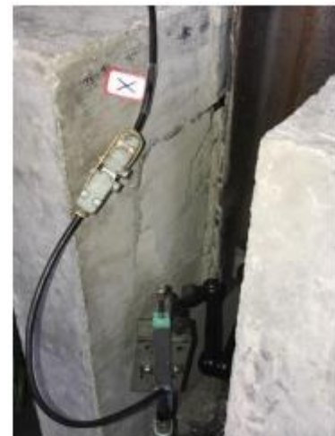
Figura 31 – Ruptura da laje de concreto no ensaio do TP45 (ASSUNÇÃO, 2018)
