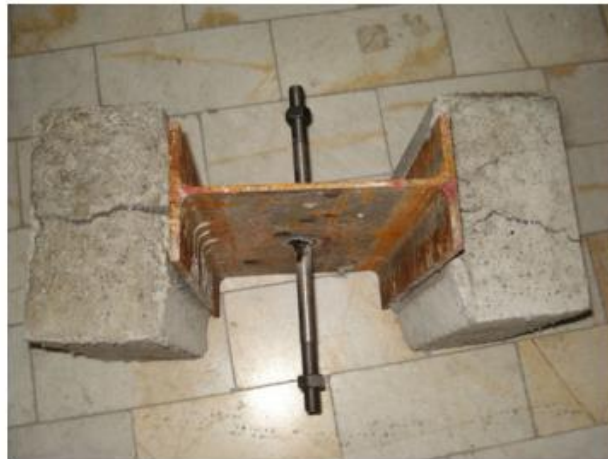
Figura 14 – Modo de ruptura do concreto (MALEKI e BAGHERI, 2008)
