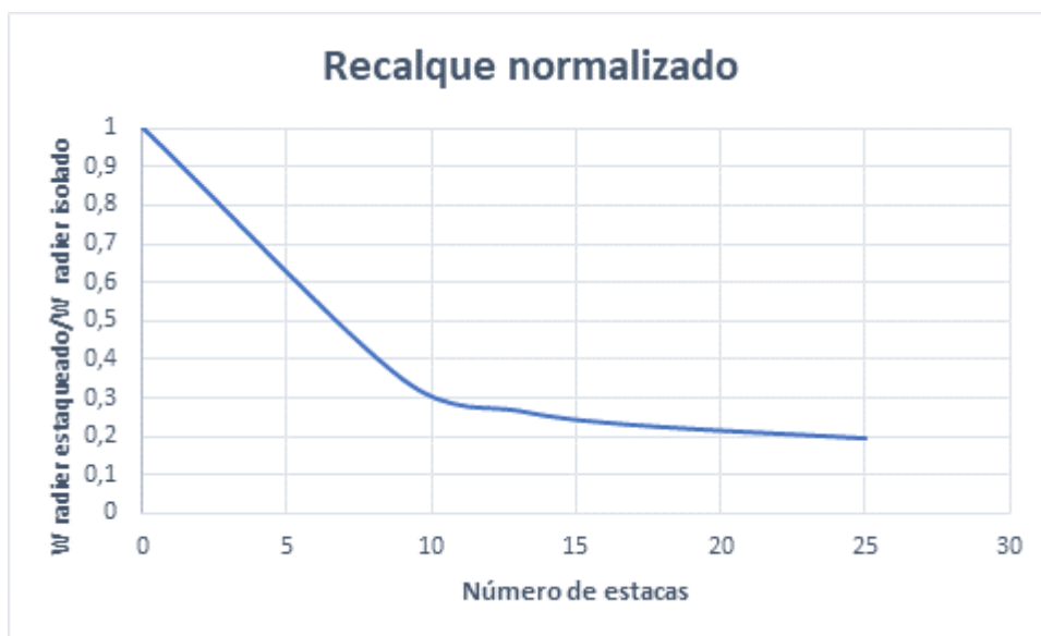
Figura 57. Recalque normalizado em função do número de estacas do radier estaqueado.
