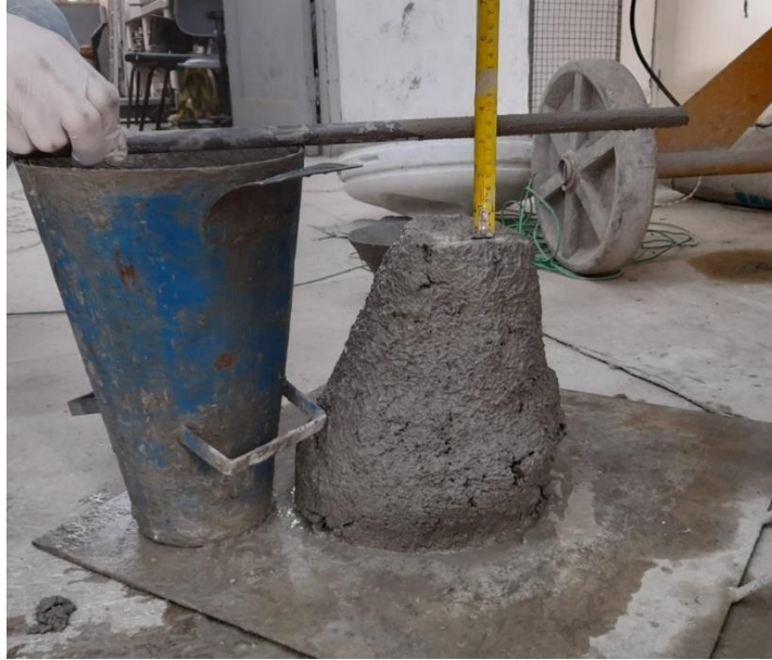
Figura 53 - Abatimento do tronco de cone da primeira concretagem da viga 2
