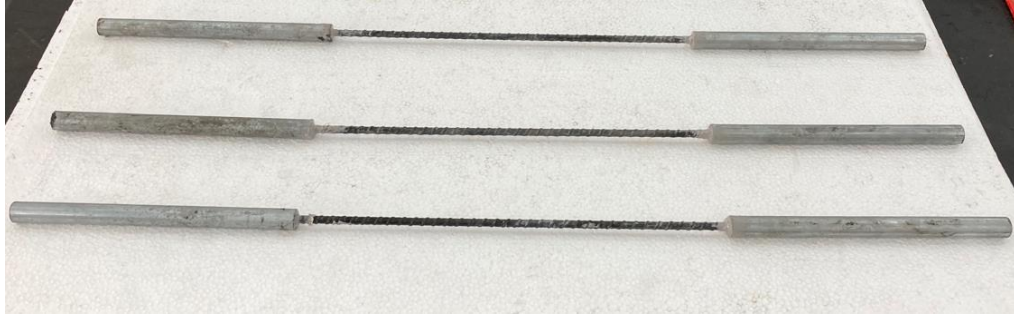
Figura 36 - Amostras preparadas para o ensaio de tração
