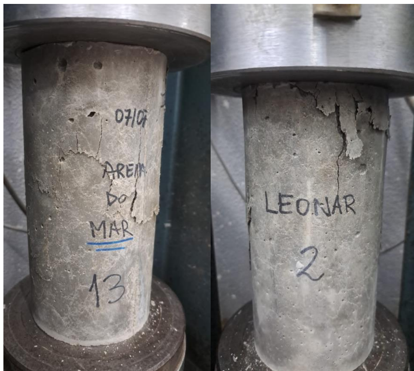
Figura 61 – Corpos de prova confeccionados com troca parcial por areia do mar rompidos após 14 dias
