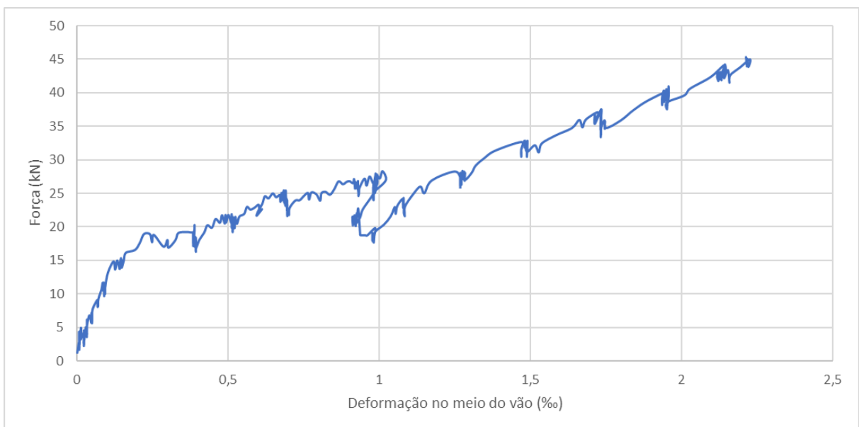
Gráfico 22 - Força x deformação no meio do vão na região mais comprimida da viga 2 (extensômetro 4)
