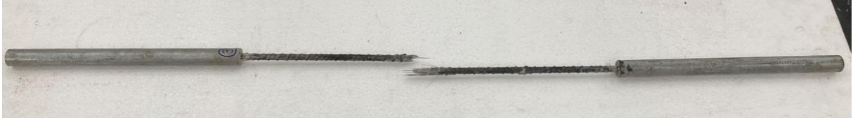
Figura 40 - Modo de ruptura da terceira amostra
