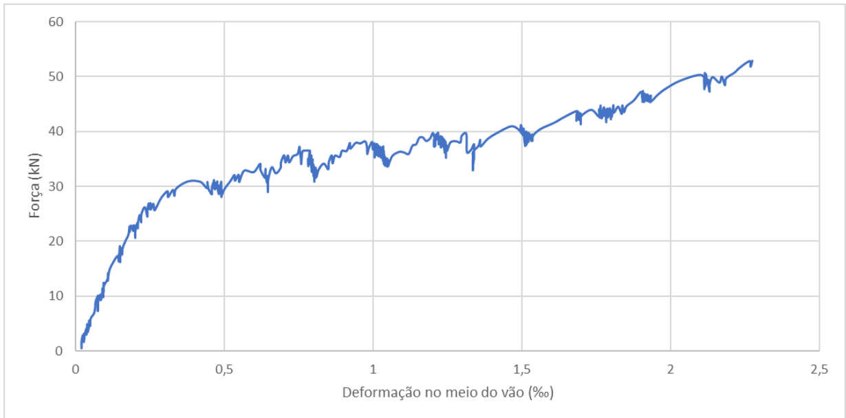
Gráfico 21 - Força x deformação no meio do vão na região mais comprimida da viga 1 (extensômetro 4)
