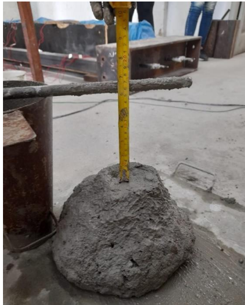
Figura 51 – Abatimento do tronco de cone da primeira concretagem da viga 1
