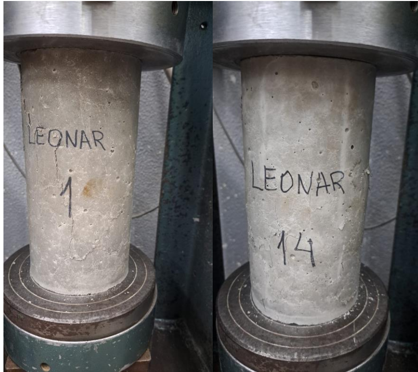
Figura 60 - Corpos de prova confeccionados com troca parcial por areia do mar rompidos após 7 dias
