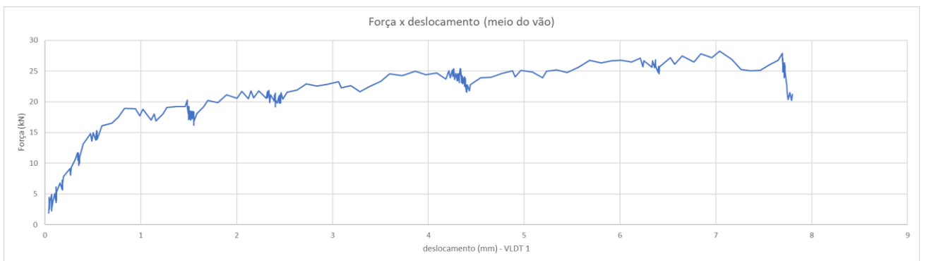
Gráfico 18 - Força x deslocamento no meio do vão (LVDT 1), viga 2
