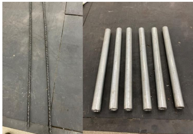
Figura 35 - Corpos de prova e tubos de aço utilizados no ensaio de tração
