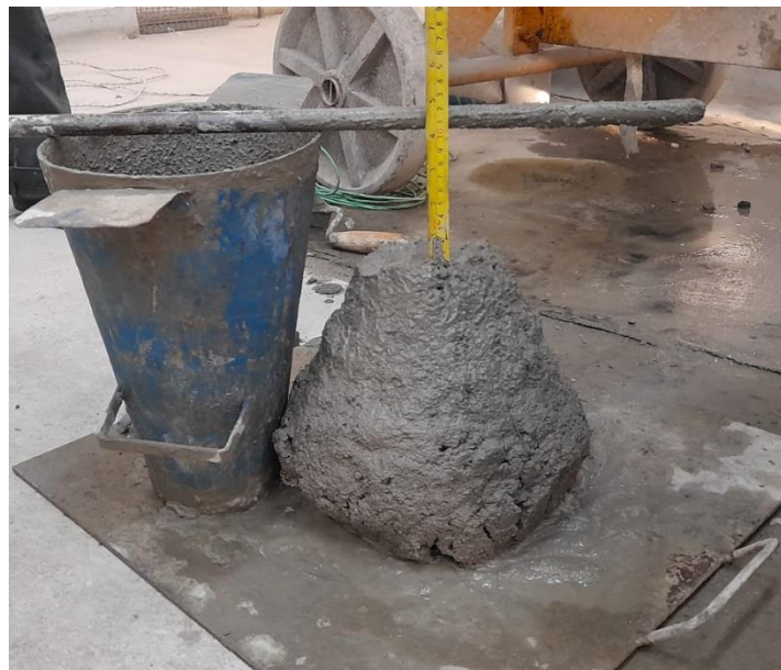
Figura 54 - Abatimento do tronco de cone da segunda concretagem da viga 2
