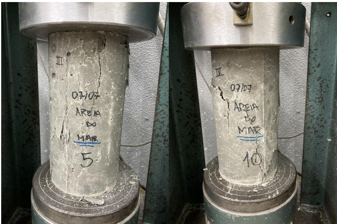
Figura 63 - Corpos confeccionados com troca parcial por areia do mar rompidos após 91 dias
