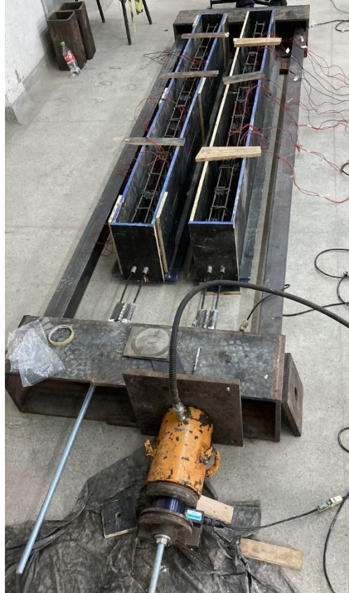
Figura 49 - Execução da protensão na viga 1
