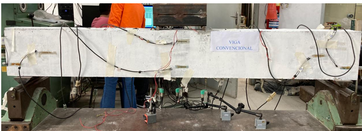
Figura 74 - Viga 1 (convencional) antes do ensaio de flexão
