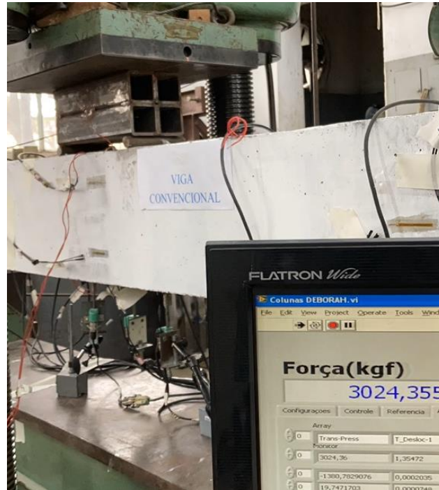
Figura 76 - Viga 1 (viga convencional) momento em que aparece a primeira fissura
