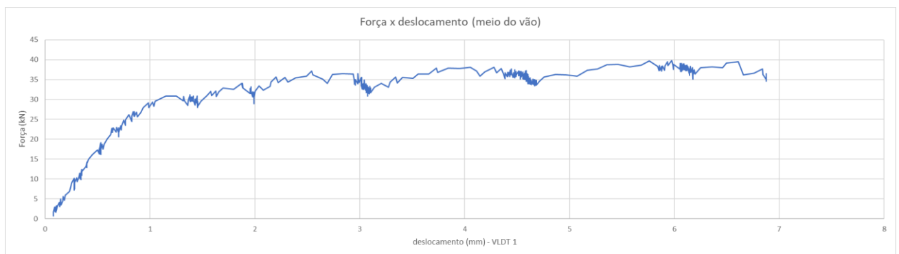
Gráfico 15 - Força x deslocamento no meio do vão (LVDT 1), viga 1
