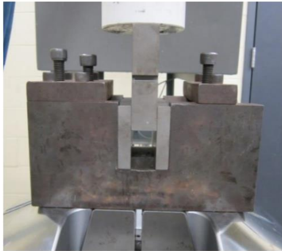
Figura 16 – Ensaio de cisalhamento nas barras de BFRP [10]
