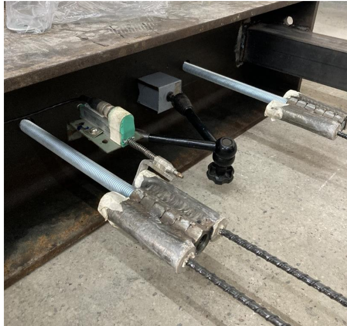
Figura 44 - Detalhe da estrutura finalizada que foi utilizada na protensão de ambas as vigas
