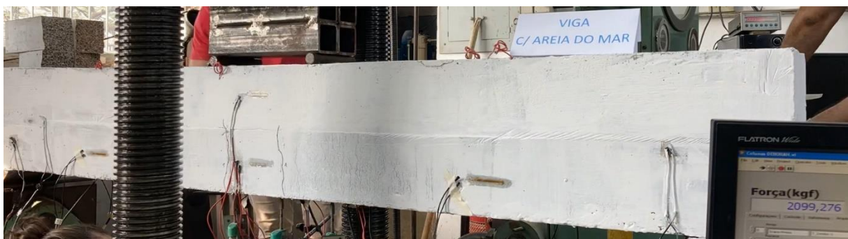
Figura 77 - Viga 2 (viga com areia do mar) momento em que aparece a primeira fissura
