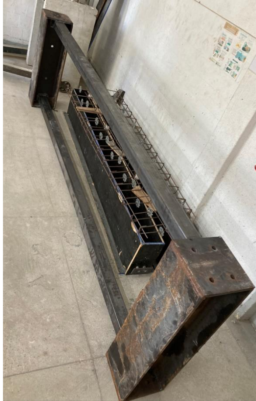
Figura 43 - Estrutura de pórtico de reação montada
