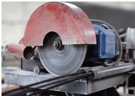
Figura 4 - Corte das barras de basalto [4]
