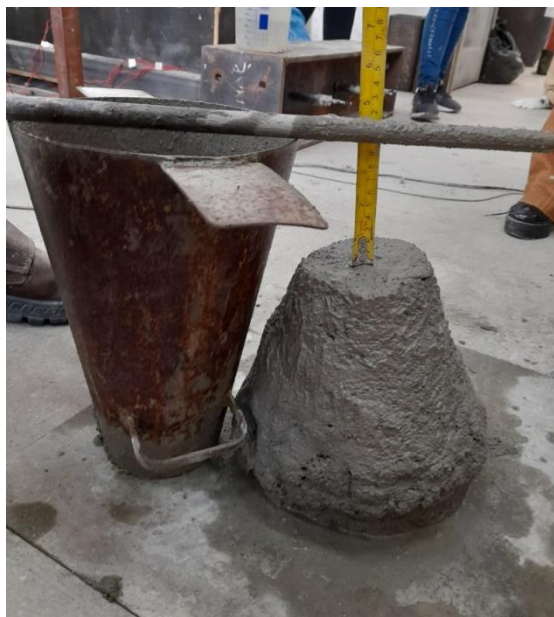
Figura 52 – Abatimento do tronco de cone da segunda concretagem da viga 1
