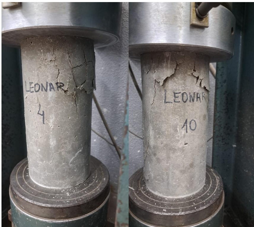
Figura 59 - Corpos de prova confeccionados com areia lavada rompidos após 80 dias
