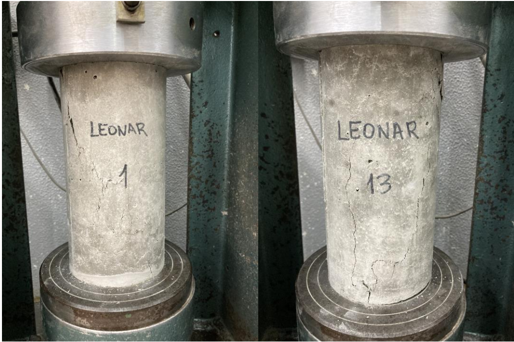
Figura 56 – Corpos de prova confeccionados com areia lavada rompidos após 7 dias
