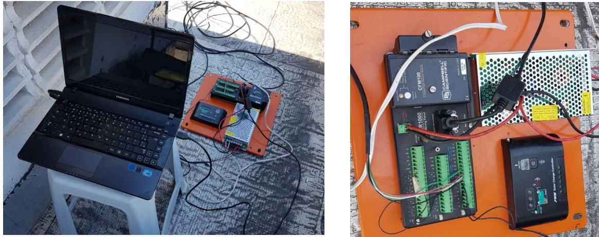
Figura 29 – Datalogger e computador para captura dos dados.
