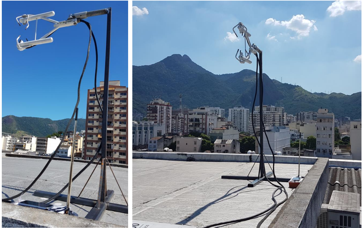
Figura 27 – Anemômetro posicionado na última laje do edifício z = 22 m.
