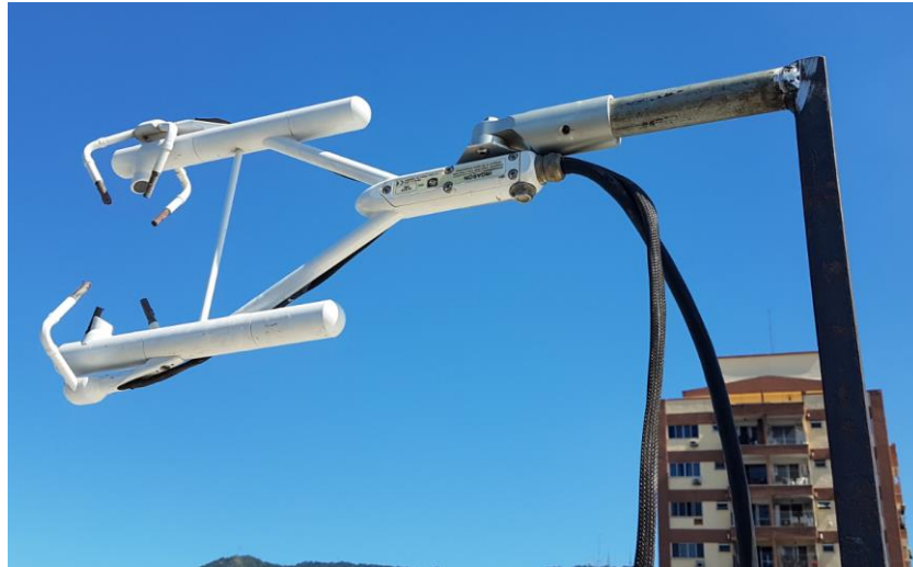
Figura 23 – Anemômetro ultrassônico 3D.
