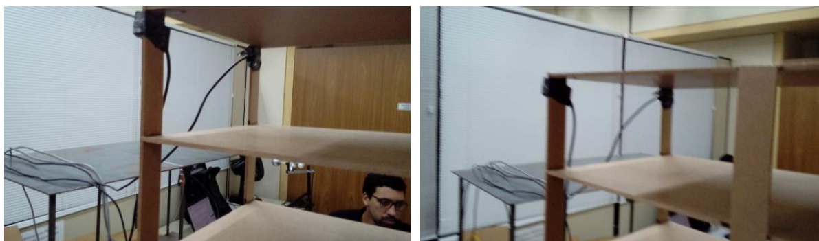
Figura H.256 – Posicionamento dos acelerômetros na estrutura investigada.
