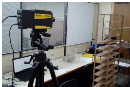
Figura H.258 – Vibrometria a laser (PDV).
