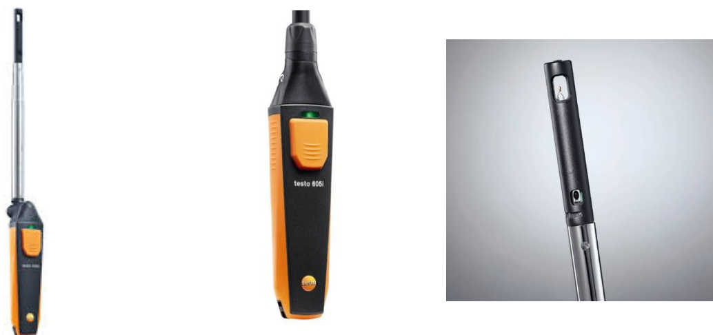
Figura G.244 – Anemômetro de fio quente
