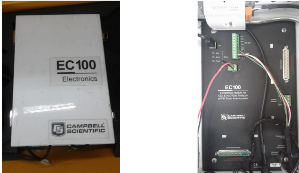
Figura 25 – Unidade de processamento EC100.
