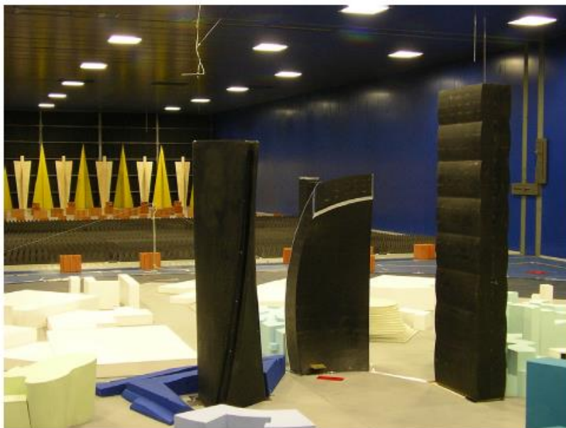
a) Ensaio em túnel de vento
