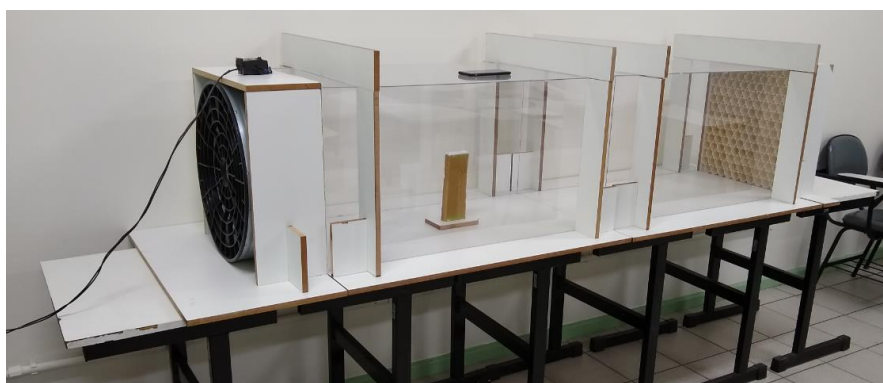
Figura 65 – Túnel de vento construído.
