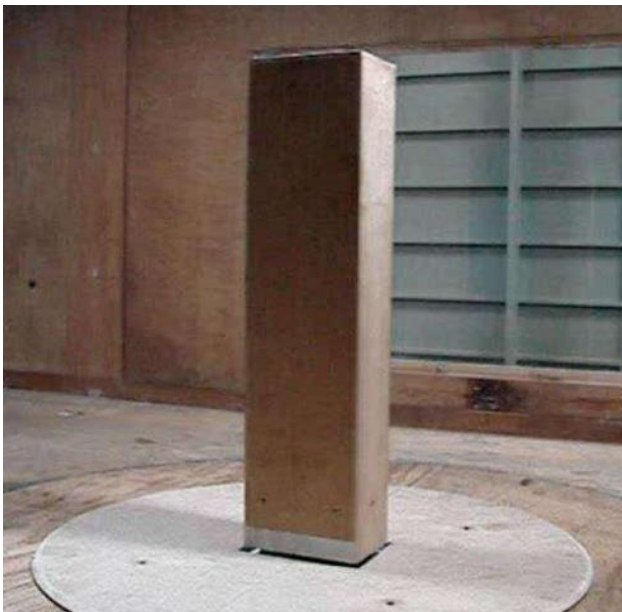
Ensaio em túnel de vento utilizando HFBB
