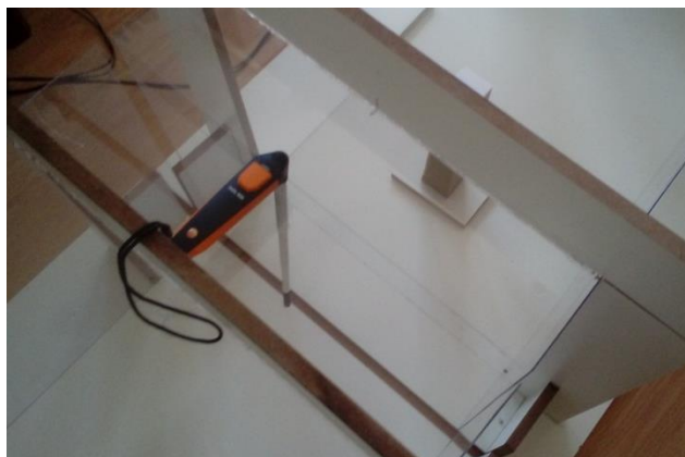
b) Anemômetro posicionado no Túnel de Vento
