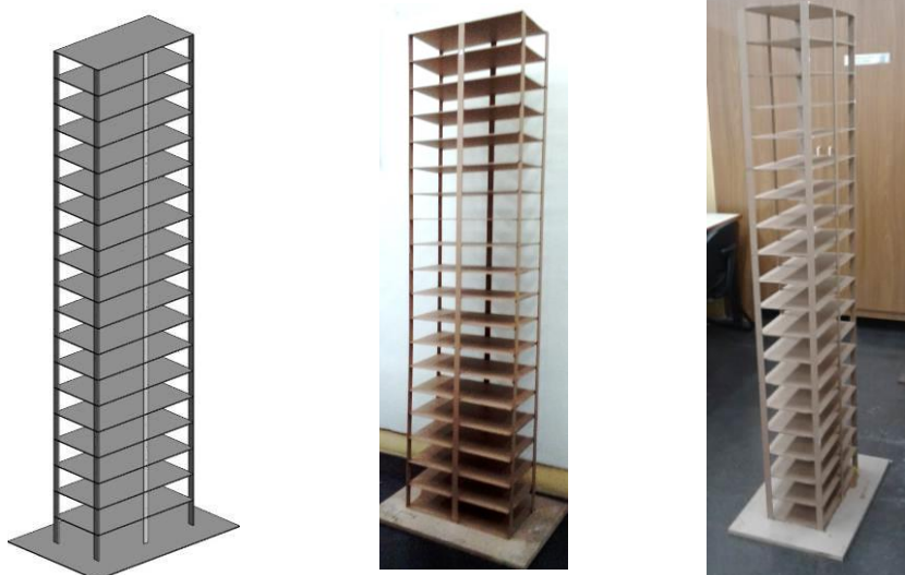
Figura H.253 – Modelo construído em laboratório com 19 pavimentos em HDF
