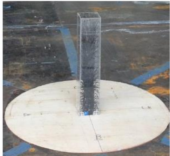
b) Modelo utilizado com os transdutores de pressão
