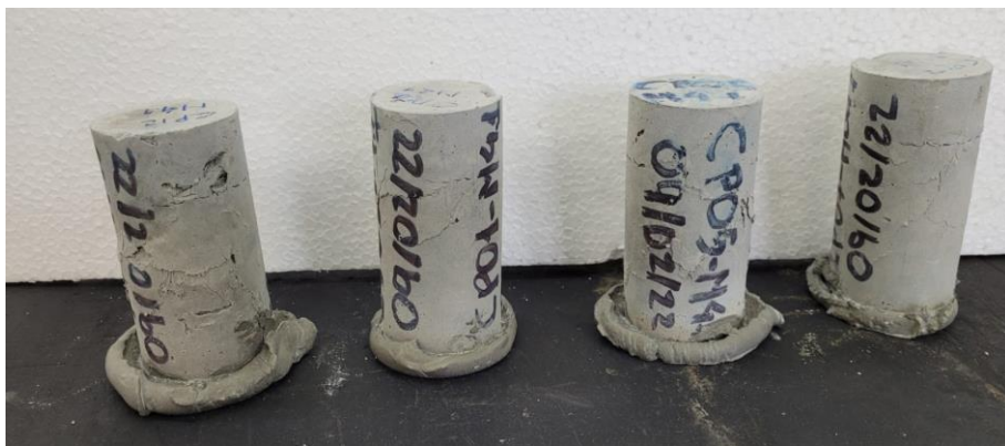
Figura 111 – Após o ensaio de compressão - Mistura M04 rompida aos 7 dias.
