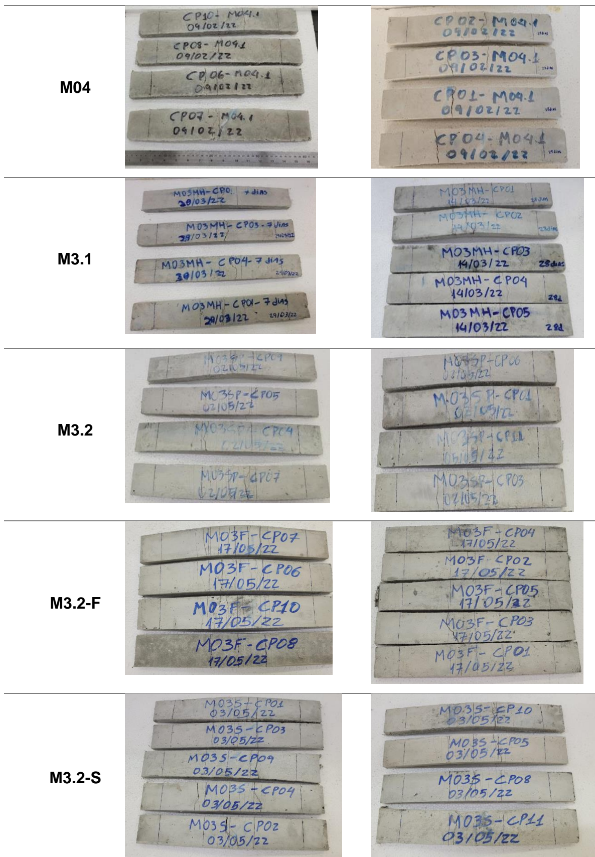
Figura 54 - Patamar de fissuração das amostras utilizadas nos ensaios de flexão aos 7 e 28 dias.
