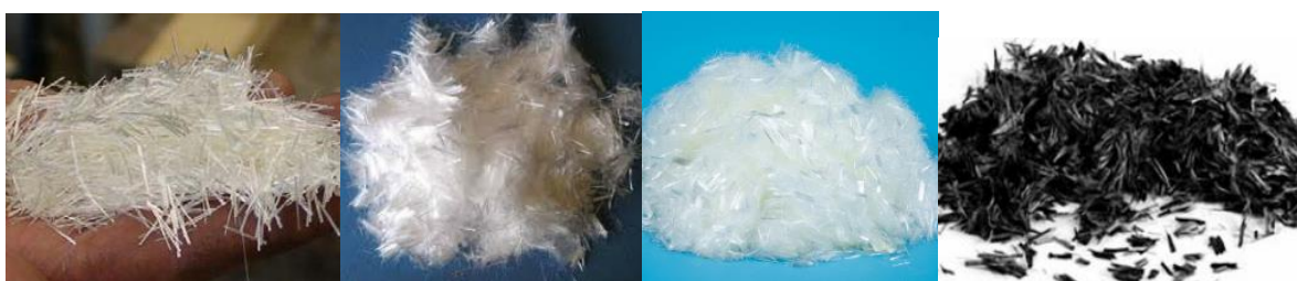
Figura 10 – Fibras curtas da esquerda para direita: Vidro, Polipropileno, PVA e Carbono. Fonte: Arboleda (2014) e autor.
