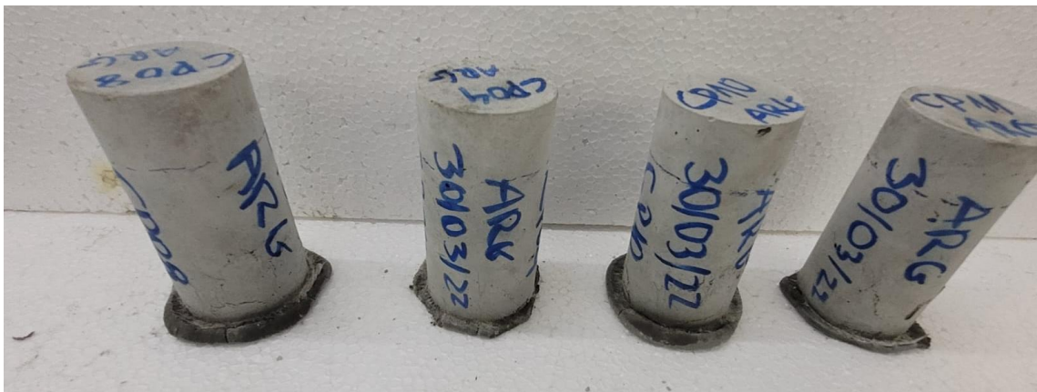
Figura 105 – Após o ensaio de compressão - Mistura M01 rompida aos 7 dias.
