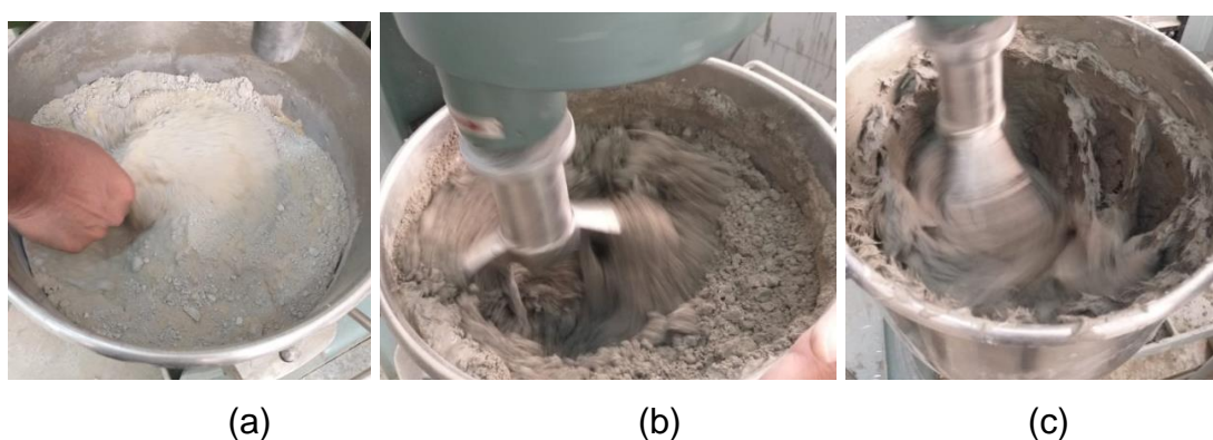
Figura 27 – (a) Mistura dos componentes sólidos na argamassadeira. (b) Aspecto da mistura antes da adição de mais água. (c) Aspecto da mistura após a adição de água.
