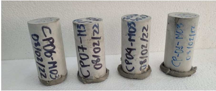
Figura 109 – Após o ensaio de compressão - Mistura M03 rompida aos 7 dias.
