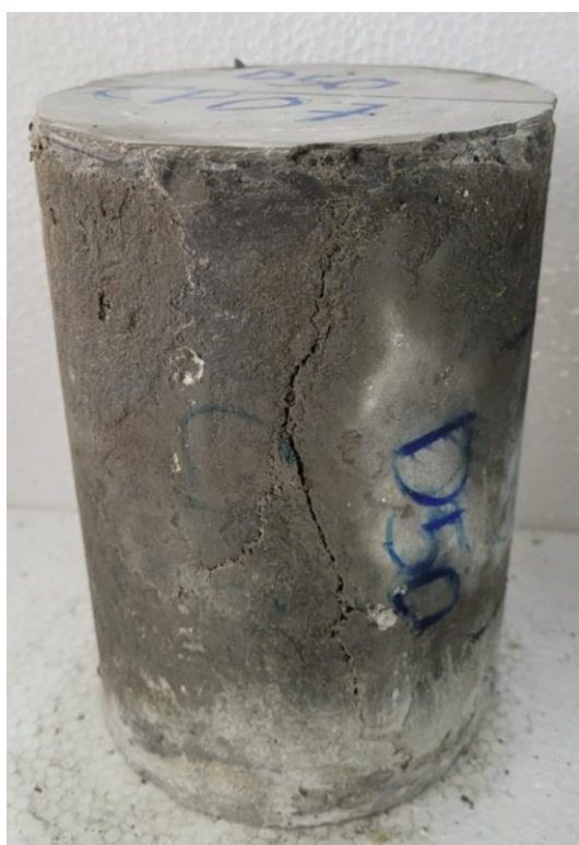
Figura 129 - Padrão de fissuração após o ensaio de compressão aos 28 dias do CP07 reparado, com dano 50% (C1-D50) camada de 2,20 cm do reparo.
