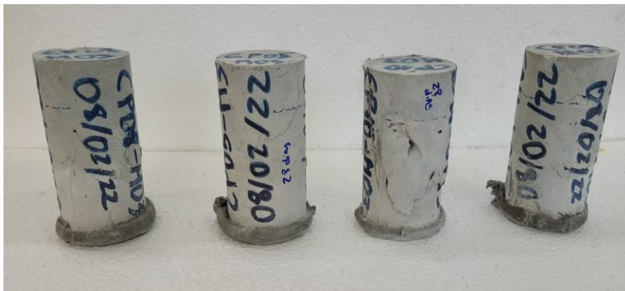
Figura 110 – Após o ensaio de compressão - Mistura M03 rompida aos 28 dias.
