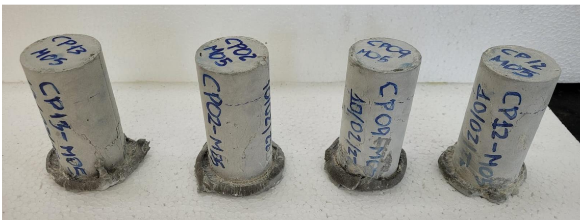
Figura 108 - Após o ensaio de compressão - Mistura M02 rompida aos 28 dias.
