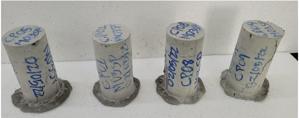
Figura 115 – Após o ensaio de compressão - Mistura M3.2 rompida aos 7 dias.
