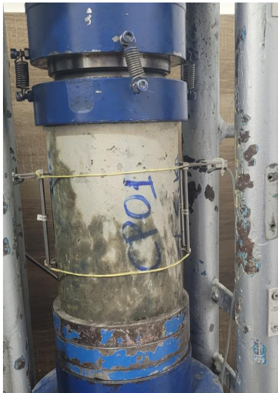
Figura 135 - Foto retirada com o CP01 preparado para a realização do ensaio de compressão aos 28 dias (CP-D80).
