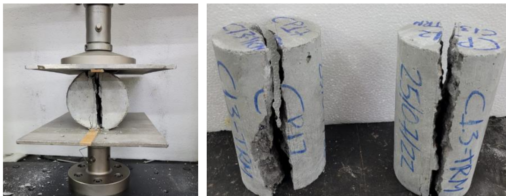
Figura 48 - Ensaio de compressão diametral dos corpos de prova de concreto.
