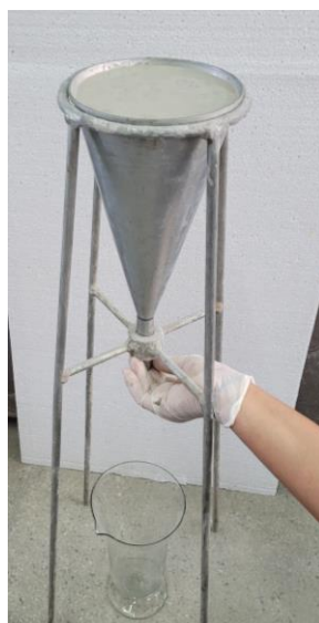
Figura 25 – Foto retirada durante o ensaio do ponto de saturação do superplastificante.
