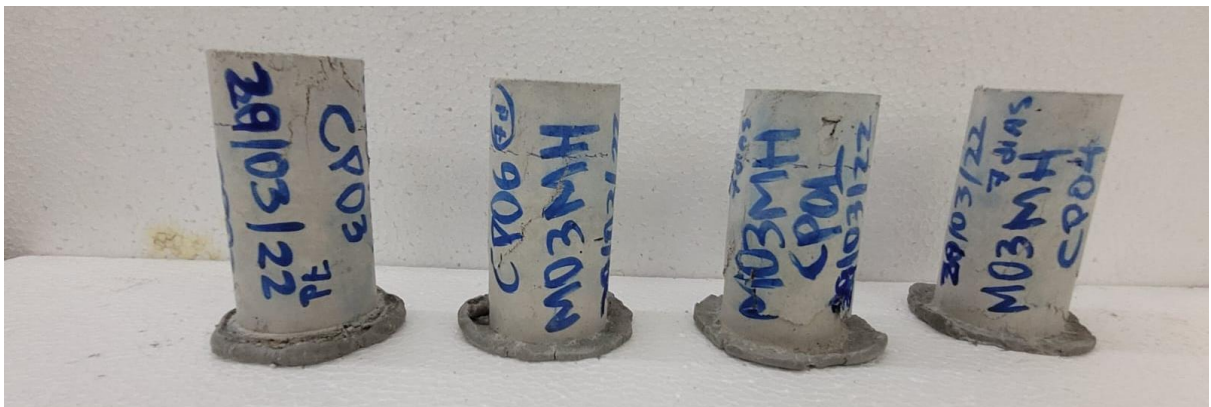
Figura 113 – Após o ensaio de compressão - Mistura M3.1 rompida aos 7 dias.
