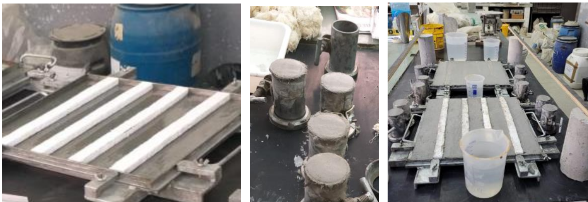
Figura 34 - Formas utilizadas no preparo dos corpos de prova do SHCC com fibra fibras curtas de PVA.
