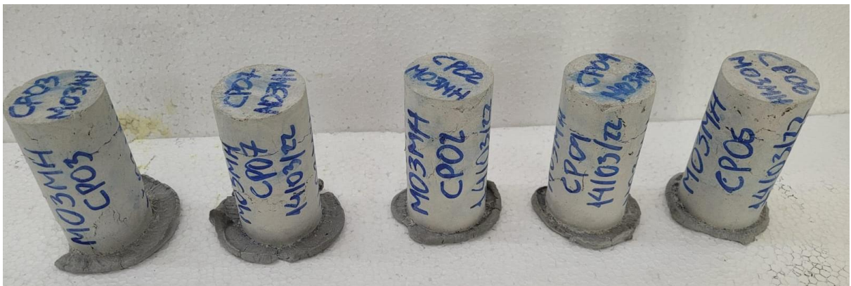
Figura 114 – Após o ensaio de compressão - Mistura M3.1 rompida aos 28 dias.
