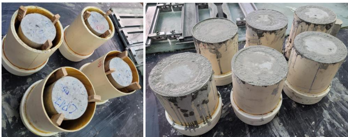
Figura 36 – Imagens da preparação do conjunto reparado.
