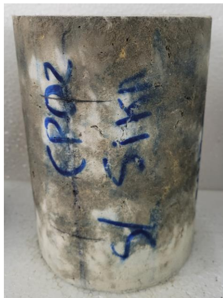
Figura 137 – Padrão de fissuração após o ensaio de compressão aos 28 dias do CP02 reparado com dano 80% (C2-D80) camada de 2,2 cm do reparo.
