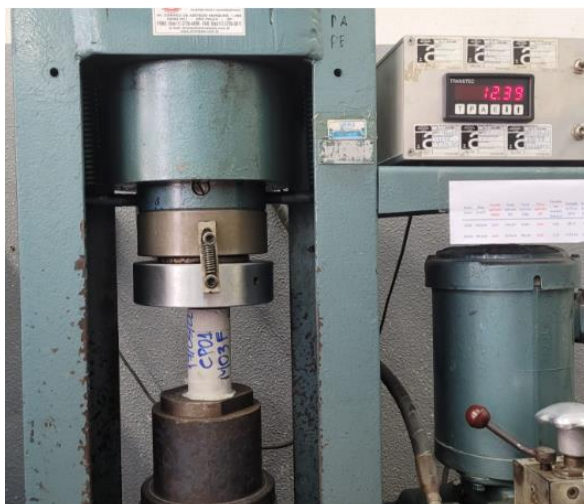
Figura 46 – Corpo de prova da mistura M3.2-F sendo rompido na máquina de ensaio da empresa Forney.
