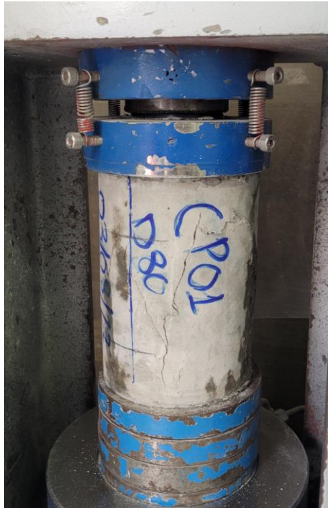
Figura 132 - Padrão de fissuração após o ensaio de compressão aos 28 dias do CP01 reparado, com dano 80% (C1-D80) camada de 2,2 cm do reparo.
