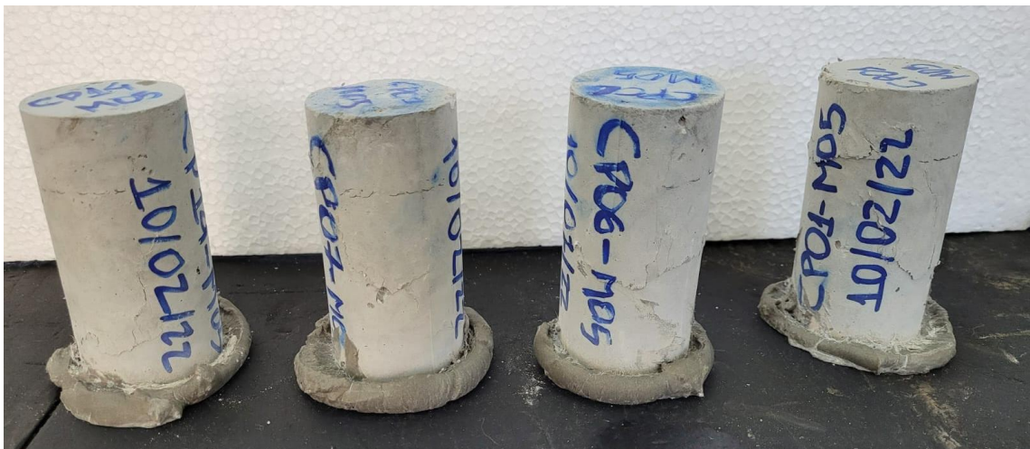
Figura 107 - Após o ensaio de compressão - Mistura M02 rompida aos 7 dias.
