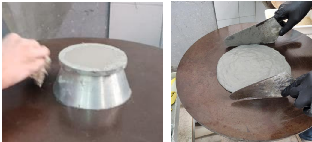
Figura 38 - Etapas do ensaio de consistência
