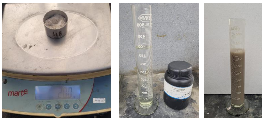
Figura 17 – Fotos retiradas durante o ensaio de determinação do índice de finura da metacaulinita.
