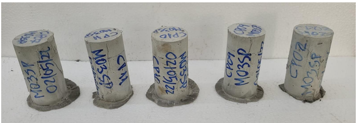
Figura 116 – Após o ensaio de compressão - Mistura M3.2 rompida aos 28 dias.
