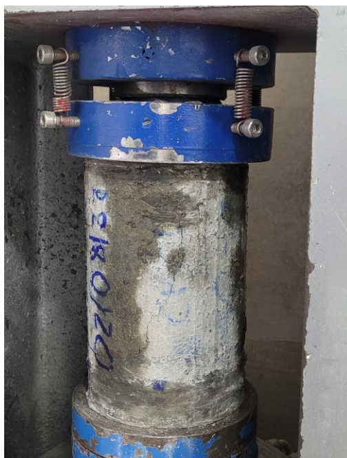
Figura 131 - Padrão de fissuração após o ensaio de compressão aos 28 dias do CP01 reparado, com dano 50% (C1-D50) camada de 1,70 cm do reparo.
