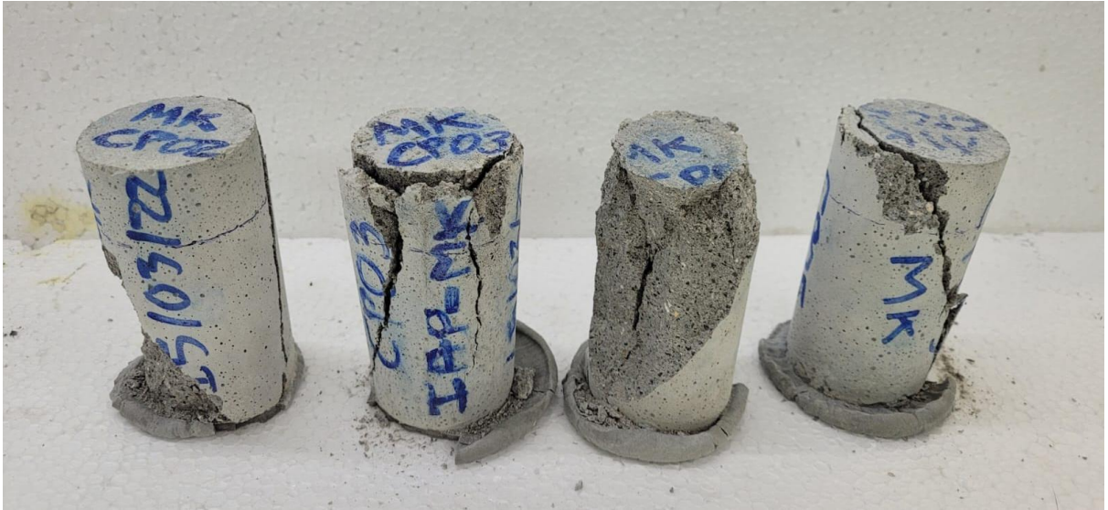
Figura 104 – Após o ensaio de compressão realizado para a determinação do índice de atividade pozolânica da metacaulinita.
