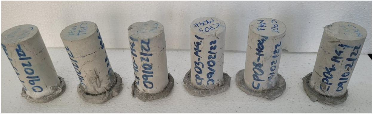
Figura 112 – Após o ensaio de compressão - Mistura M04 rompida aos 28 dias.
