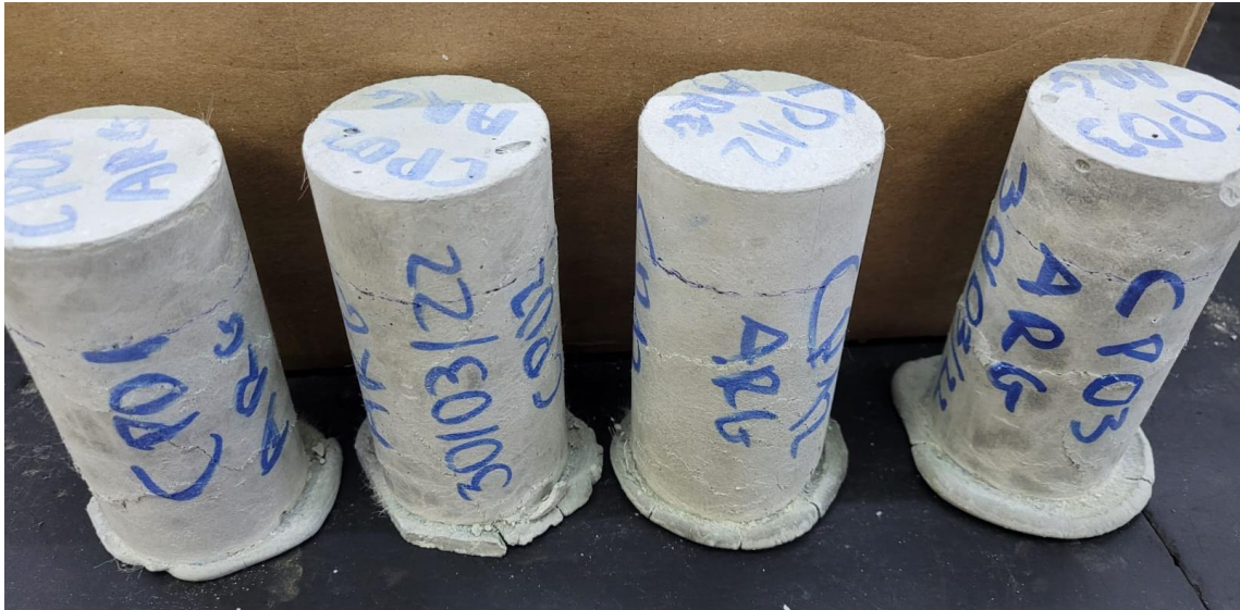
Figura 106 – Após o ensaio de compressão - Mistura M01 rompida aos 28 dias.
