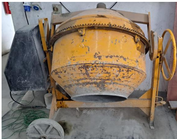
Figura 35 – Betoneira utilizada para a concretagem.
