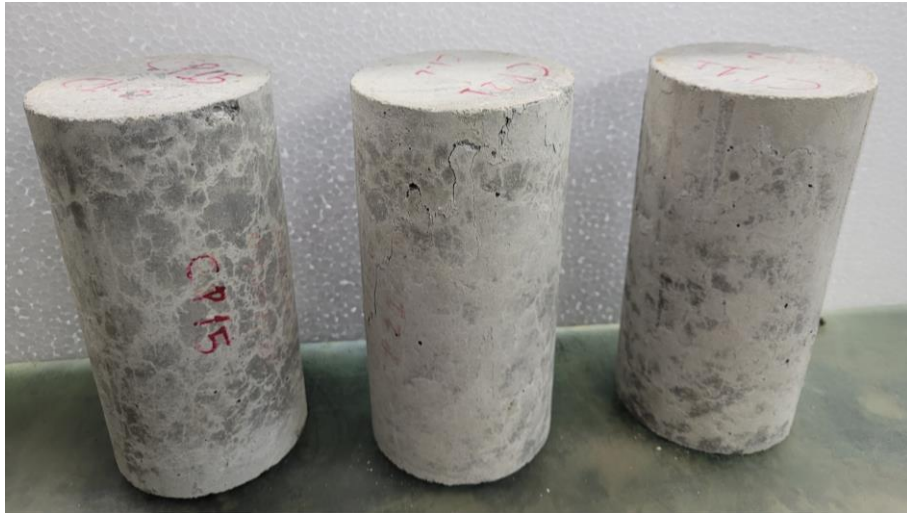
Figura 121 – Amostras da concretagem C1 rompidos após 28 dias de cura para a sua caracterização.
