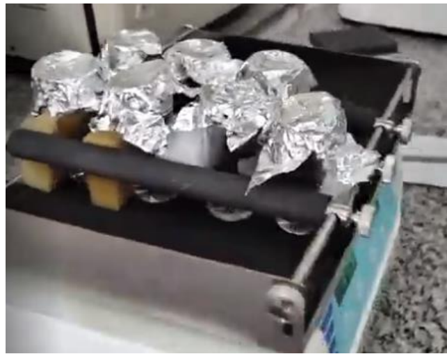
Figura 13 - Experimento laboratorial montado de tratamento sortivo de remoção de saxitoxina em água ultrapura fortificada.
